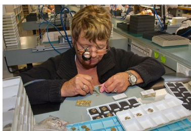
Atelier de fabrication : pose des aiguilles. Phot. Yves Sancey IVR43_20122501733NUC2A
