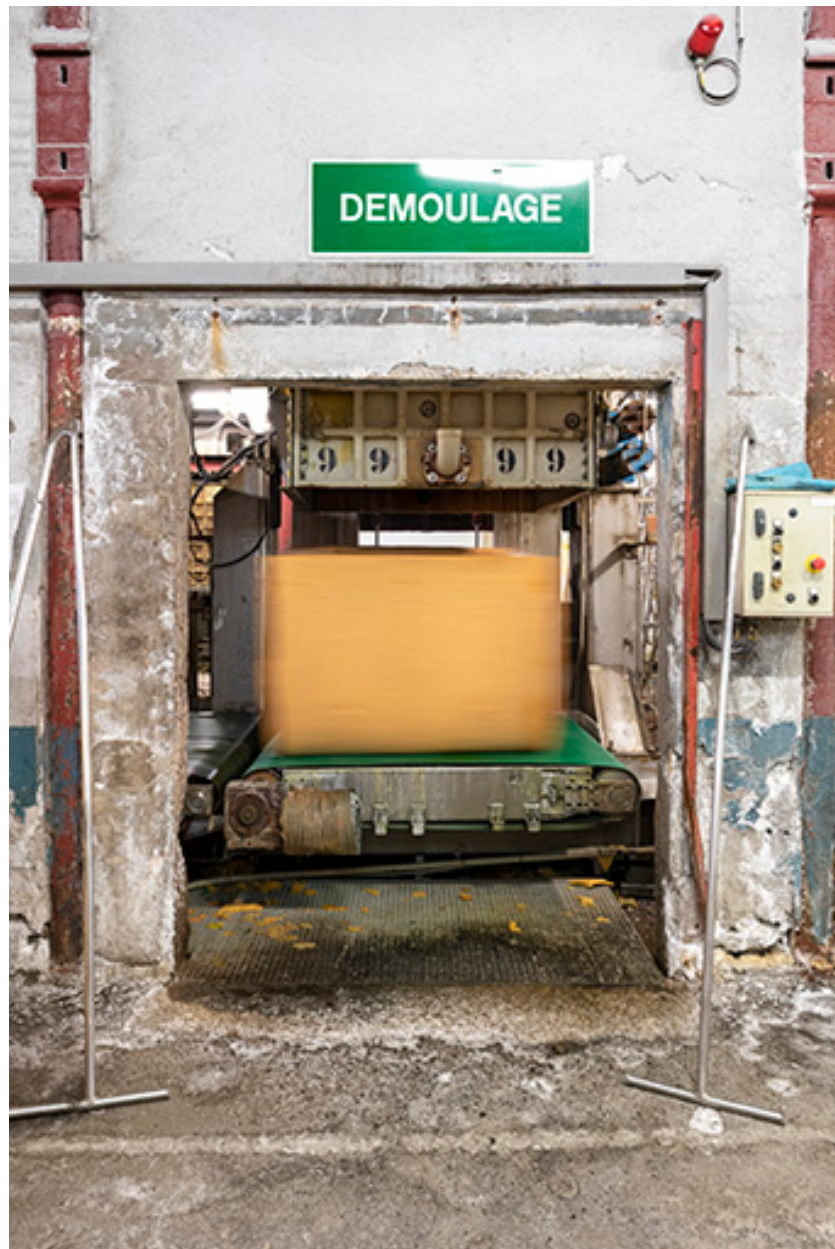
Fabrication : démoulage du bloc.
