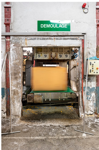
Fabrication : démoulage du bloc.
