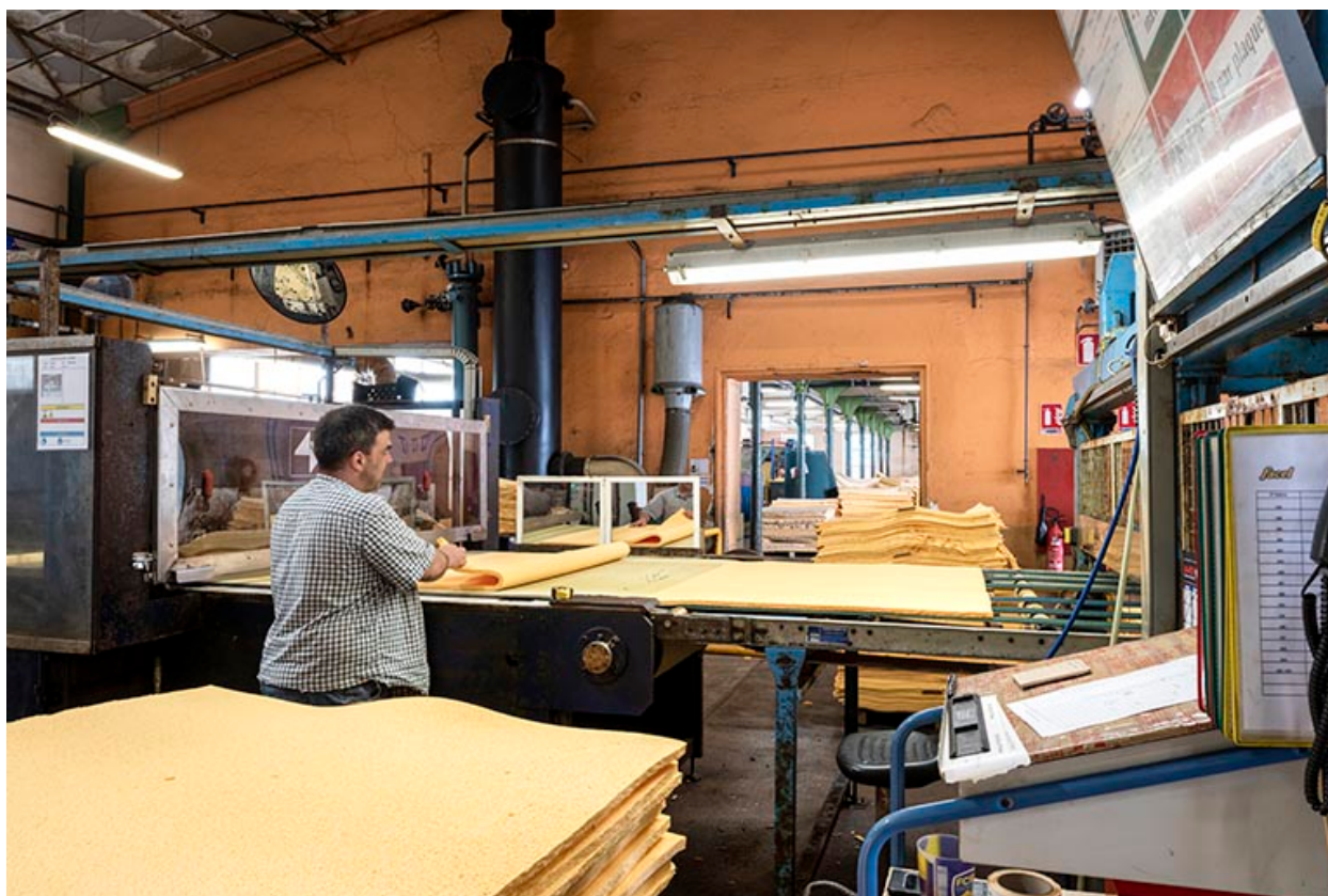
Fabrication : découpe et contrôle des plaques.
