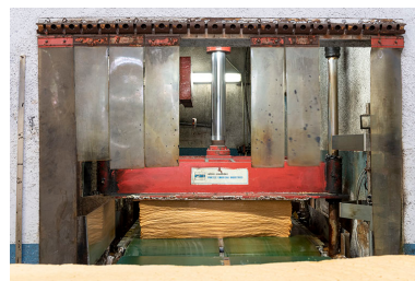
Fabrication : pressage du bloc.
