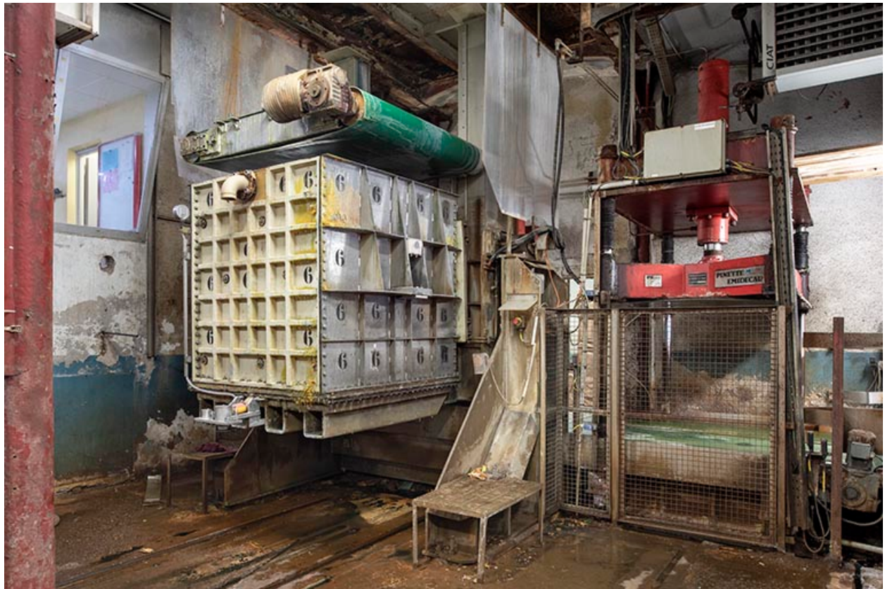
Fabrication : moule sur le poste de démoulage, avec presse à droite.
