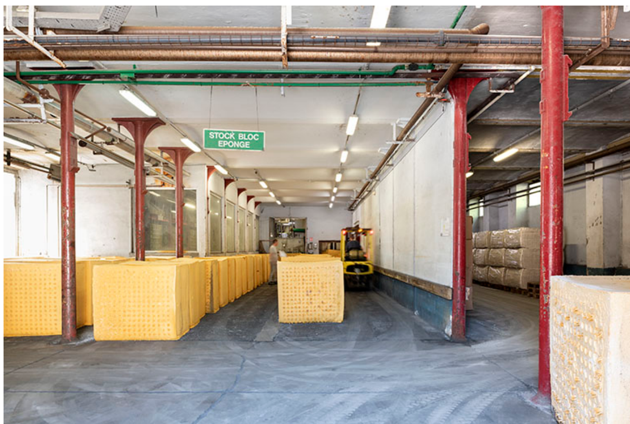
Fabrication : stockage temporaire des blocs juste démoulés.
