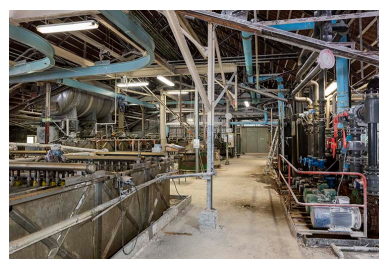
Fabrication : retraitement du sel (cristallisation). Phot. Sonia Dourlot IVR43_20192500583NUC4A
