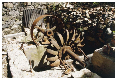
Turbine Pelton et volant de transmission. La turbine a vraisemblablement été apportée après la fermeture du tissage, peut- être dans l'intention de fournir de l'électricité à la pisciculture.
