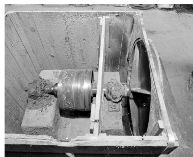
Vue plongeante sur le mécanisme d'entraînement (carcasse enlevée). Phot. Yves Sancey IVR43_20022501019X
