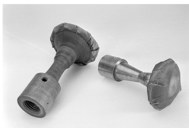
Détail de deux disques de polissage. Phot. Jérôme Mongreville IVR43_20003900978X
