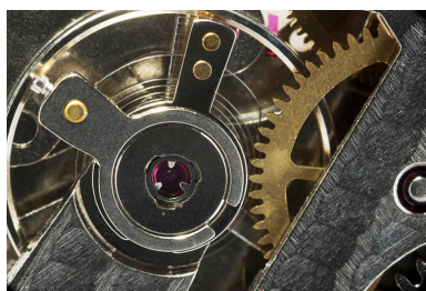
Mouvement FE 233-68-E-21 : l'amortisseur de chocs Epsilon Antichoc 108. Phot. Sonia Dourlot IVR43_20162500758NUC4A
