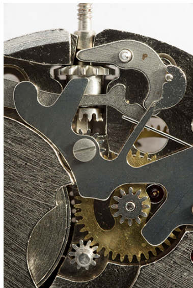
Mouvement FE 233-68- E-21 : la tirette. Phot. Sonia Dourlot IVR43_20162500756NUC4A
