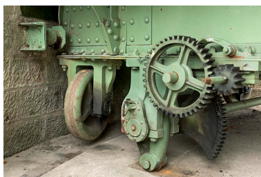
Détail du système de levage.
