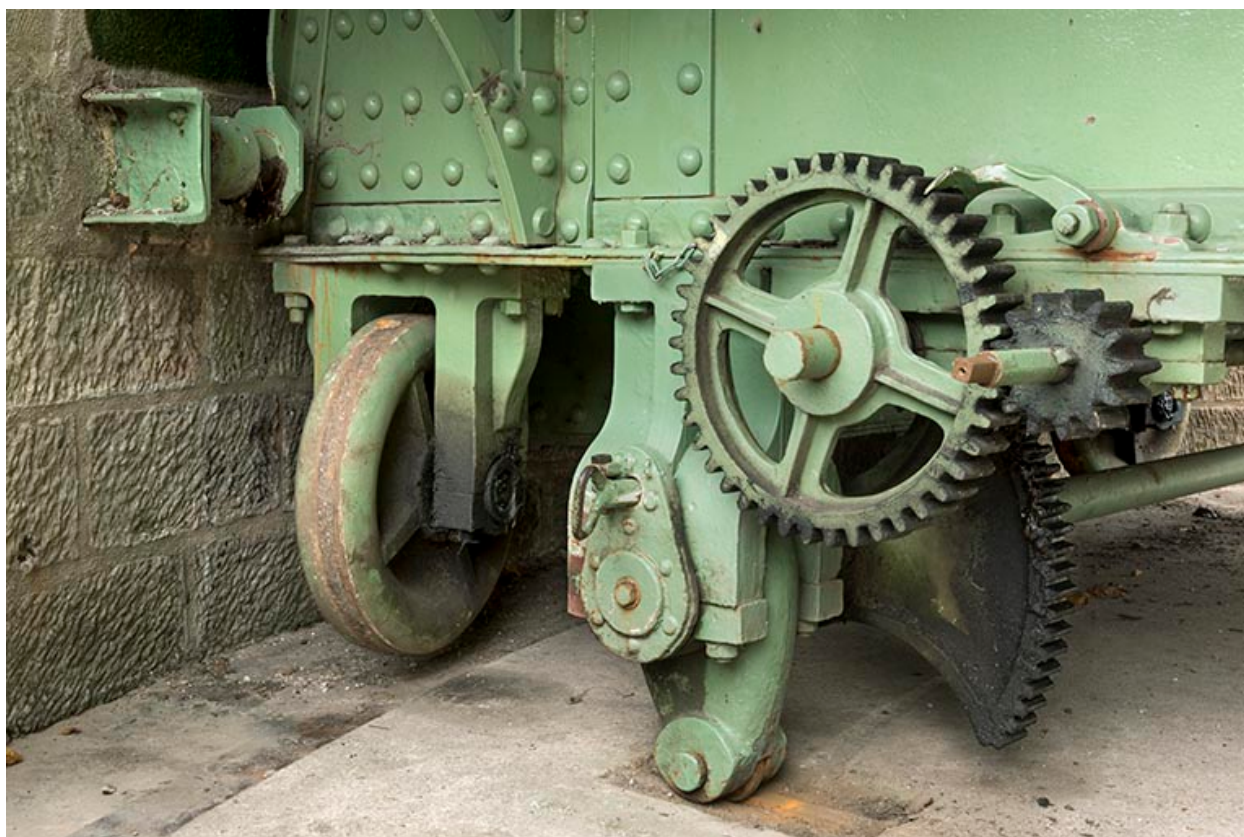
Détail du système de levage.
