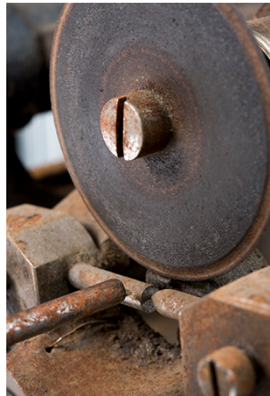
Système de fixation de la roue de cylindre. La roue est pincée entre les deux tiges métalliques parallèles à la meule ; la tige perpendiculaire (à gauche) s'achève par un saphir servant de support à une dent. et meule en carborandum.
