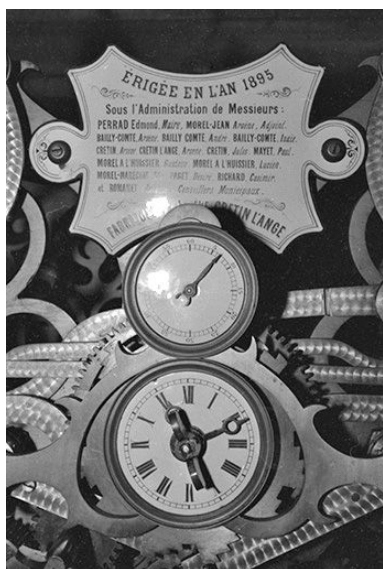
Cadrans de réglage et de contrôle, et plaque émaillée. Phot. Jérôme Mongreville IVR43_20003900723Z
