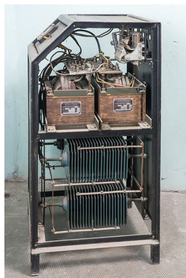
Redresseur Rectarc désaffecté : vue de profil, tôle de protection enlevée. Phot. Pierre-Marie Barbe-Richaud IVR26_20222100056NUC4A
