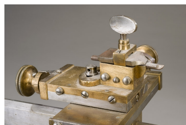
Détail du chariot porte- outil et du burin. Phot. Marc Loukachine IVR43_20122500082NUC4A
