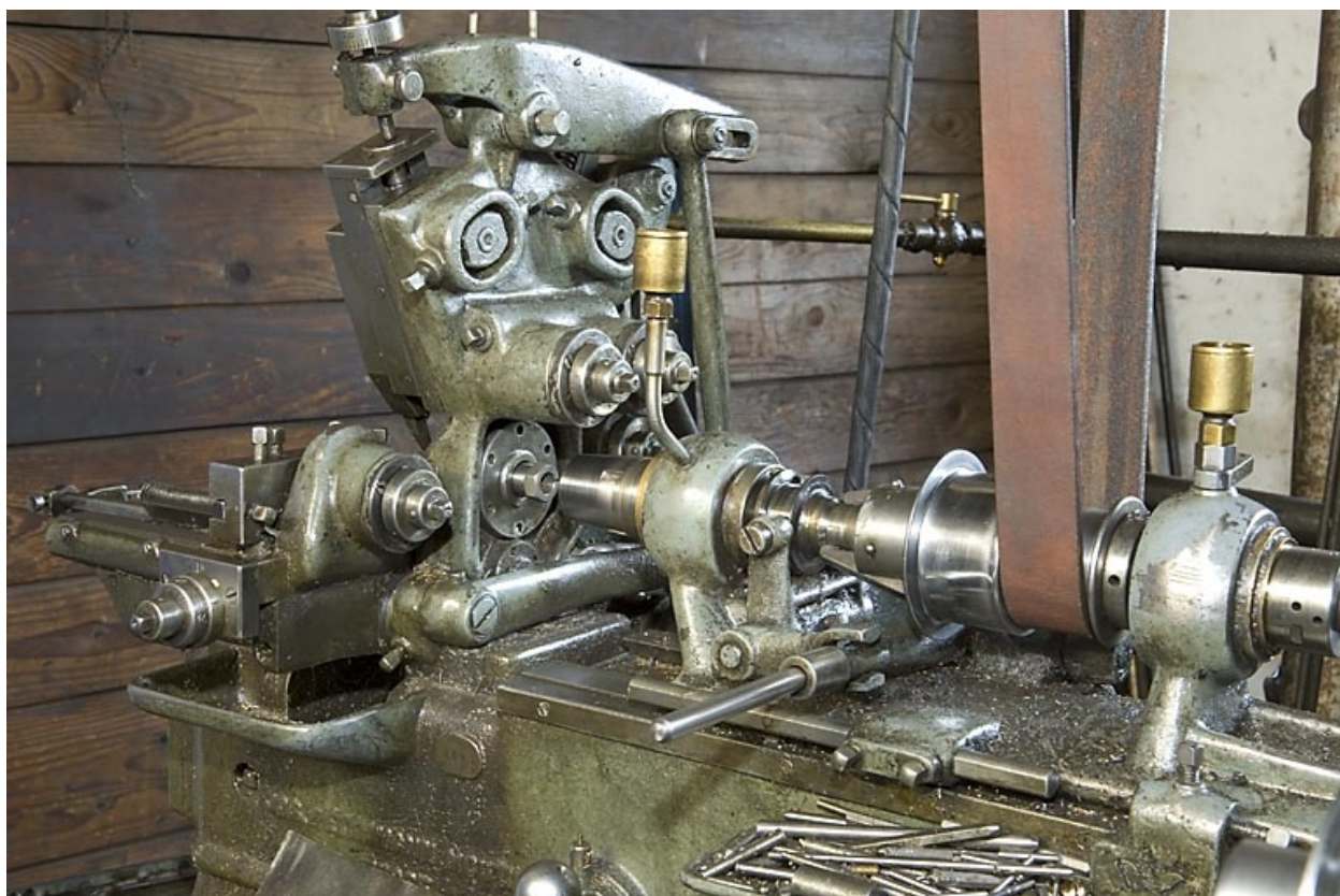
Tour à décolleter Petermann (M). Détail du système d'entraînement de la poupée mobile.
