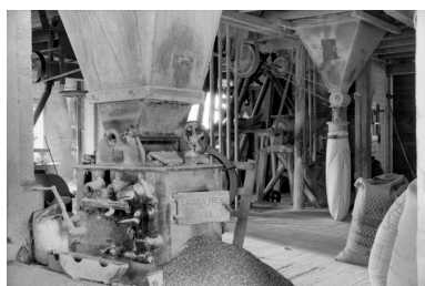
Appareil à cylindres Lacroix. Phot. Laurent Poupard IVR43_19883900705Z
