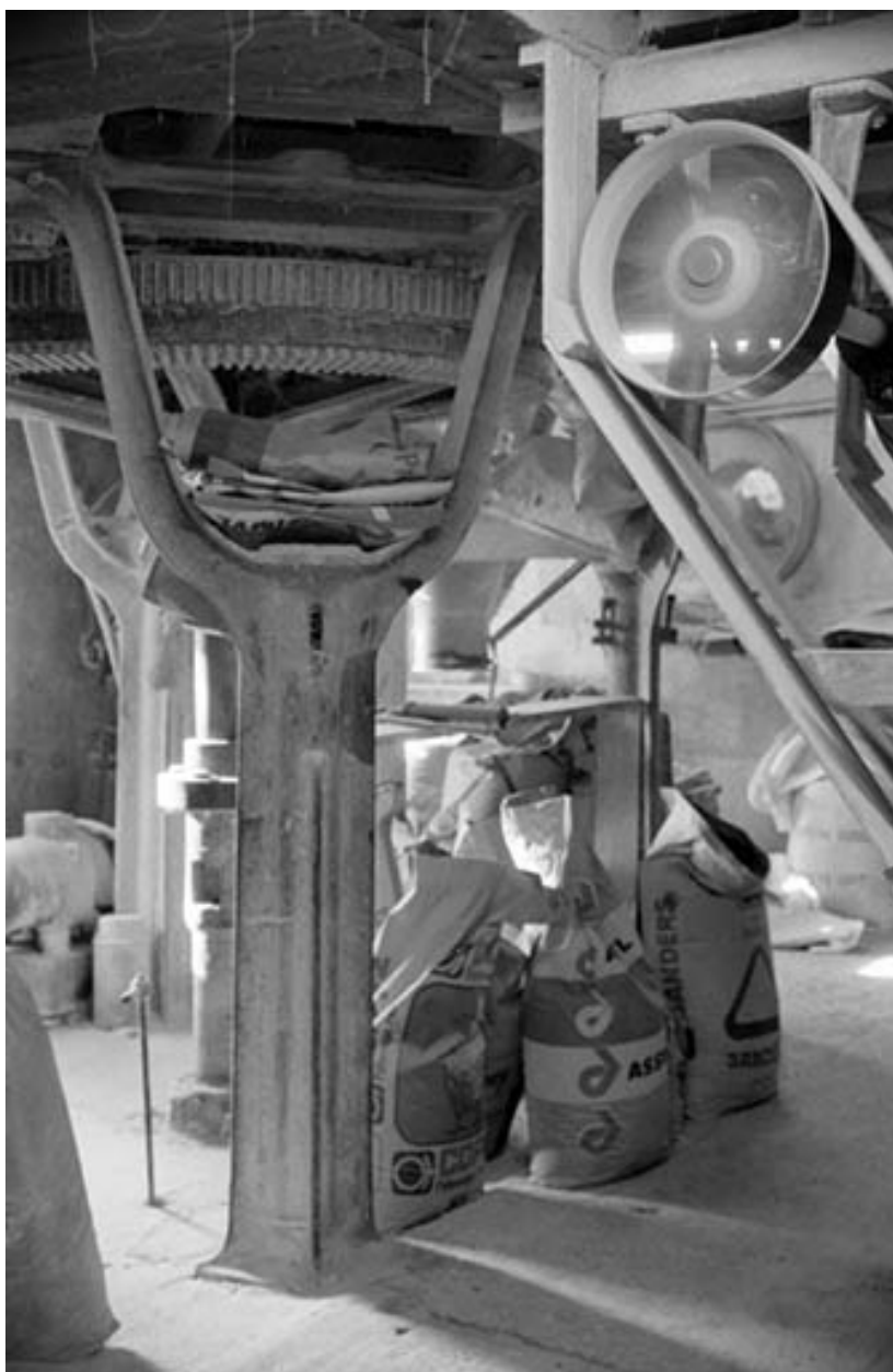
Transmission et support de meules (beffroi).
