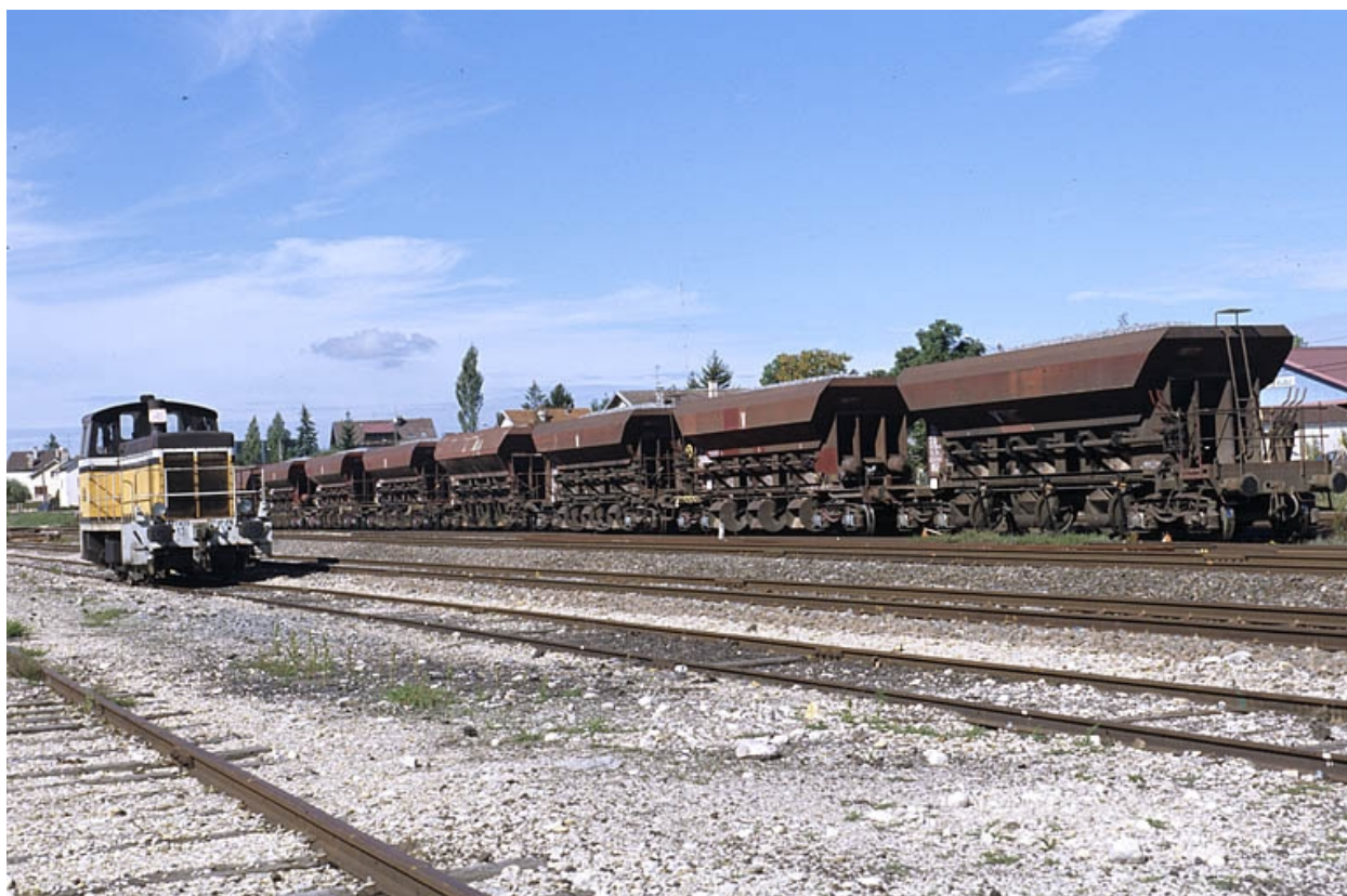
Locomotive diesel Y 7400 (n° Y 7435) et wagons-trémies.
