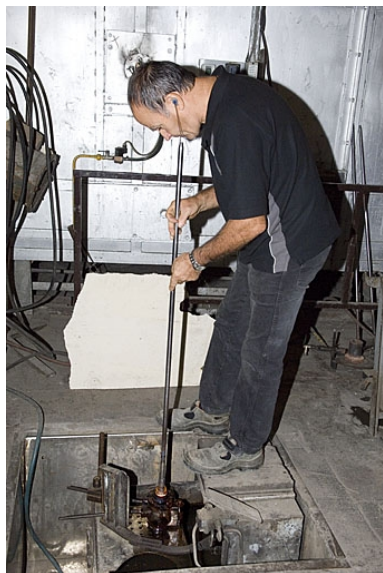
Soufflage dans le moule, dit "gamin mécanique". Phot. Jérôme Mongreville IVR43_20077000918NUCA
