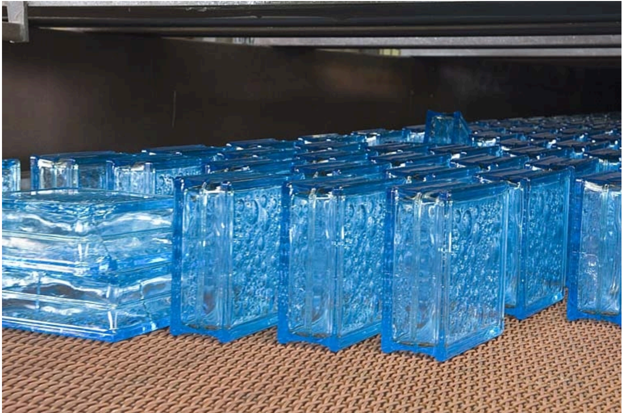
Four à cuire. Pavés de verre en fin de cuisson.
