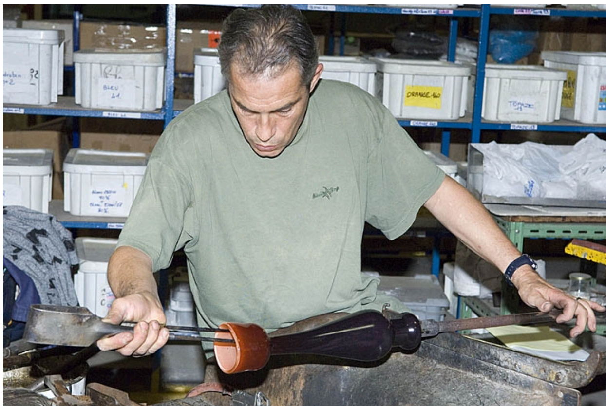
Façonnage du pied de la lampe (2).
