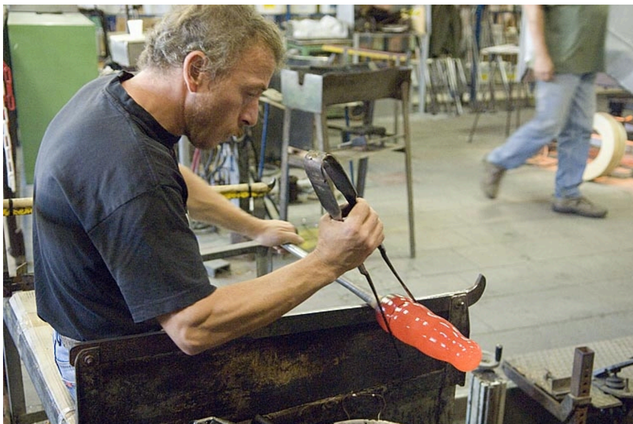
Façonnage d'un pied de lampe.
