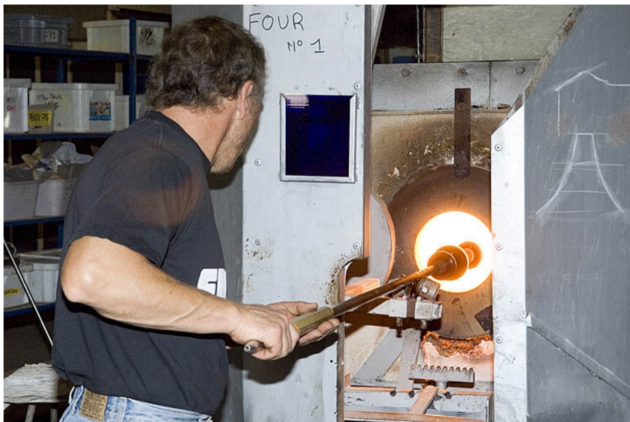
Four à réchauffer.
