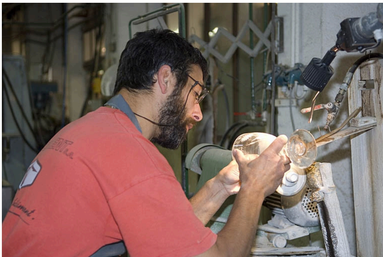
Atelier de finition ou parachèvement. Taille de verre (2).
