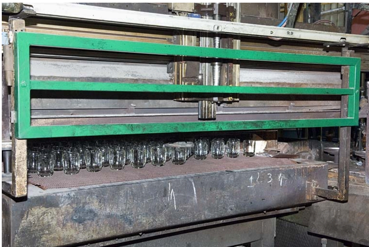
Four à recuire (atelier Articles de table).
