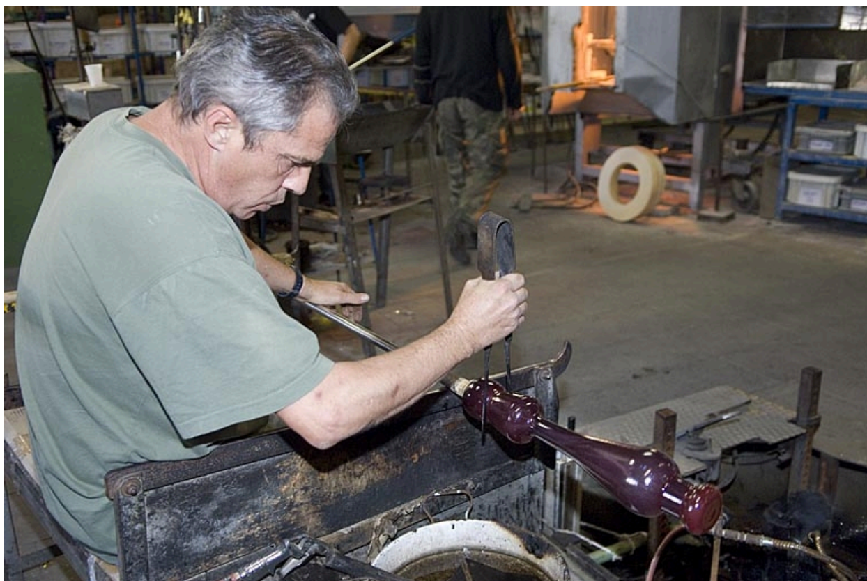
Etirage d'un pied de lampe.
