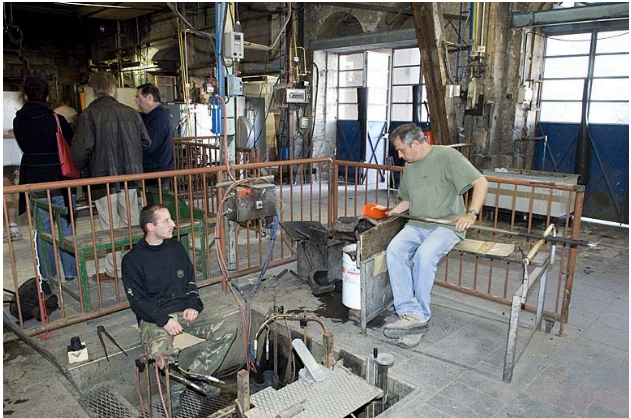
Poste de moulage (ou "gamin mécanique").
