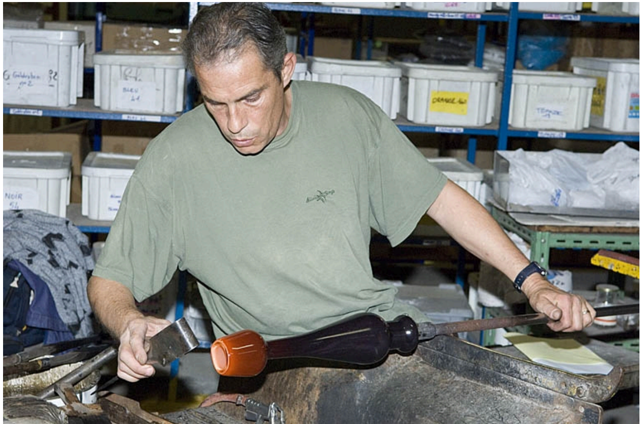
Façonnage du pied de la lampe (1).
