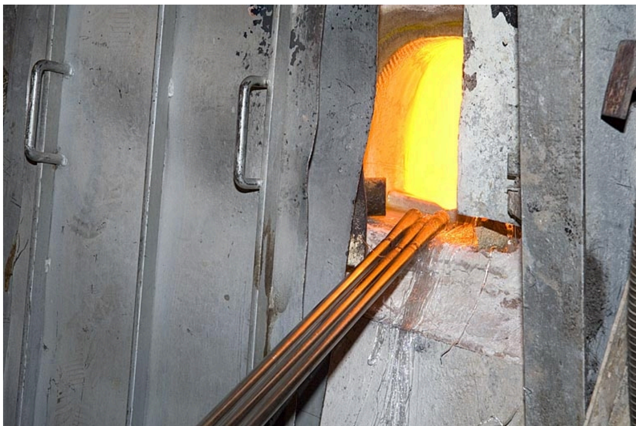
Four à pots. Canes et ouverture.
