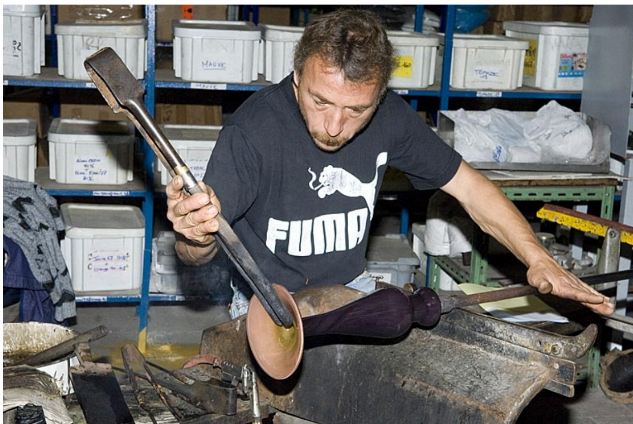
Façonnage du pied de la lampe.
