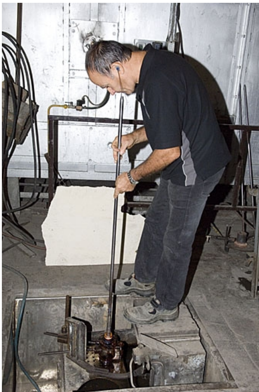
Soufflage dans le moule, dit "gamin mécanique".
