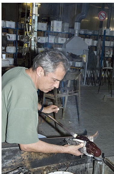
Façonnage d'un pied de lampe. Phot. Jérôme Mongreville IVR43_20077000902NUCA
