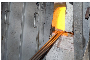
Four à pots. Cannes et ouverture. Phot. Jérôme Mongreville IVR43_20077000924NUCA
