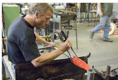
Façonnage d'un pied de lampe. Phot. Jérôme Mongreville IVR43_20077000911NUCA
