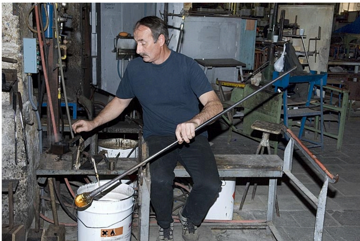
Préparation de la paraison pour le maillochage.
