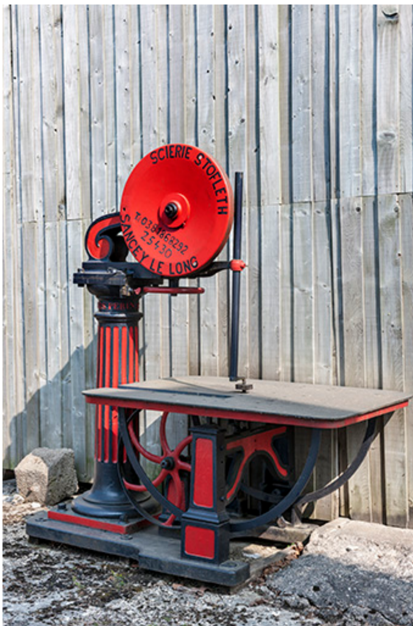
Moulin des Calots, actuellement scierie Stofleth, Sancey-le-Long : scie à ruban Perrin (Paris).
