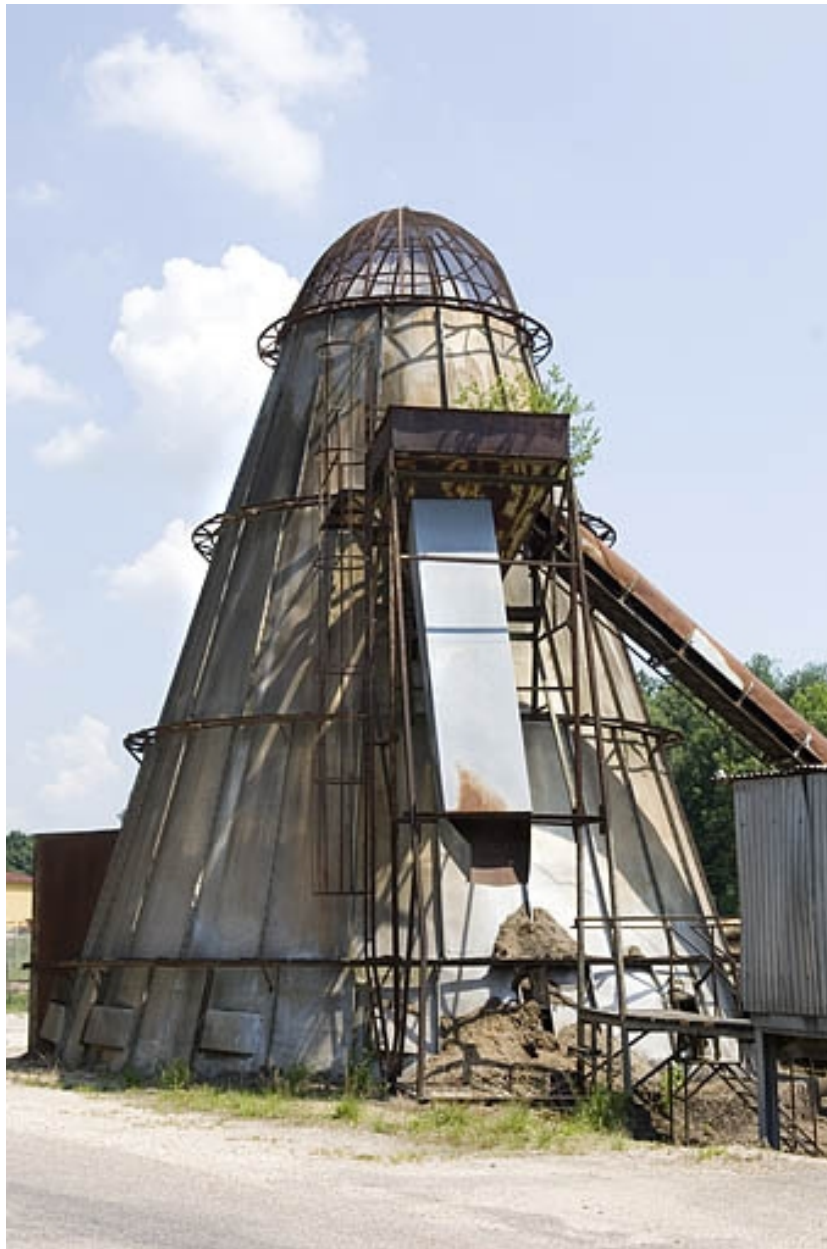
Scierie et menuiserie Detroye, Corre : four à écorces américain.
