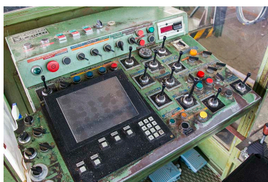
Scierie Filisetti, Cour-Saint-Maurice : pupitre du poste de commande de la scie Gillet et Vigneau. Phot. Yves Sancey IVR43_20132501291NUC2A
