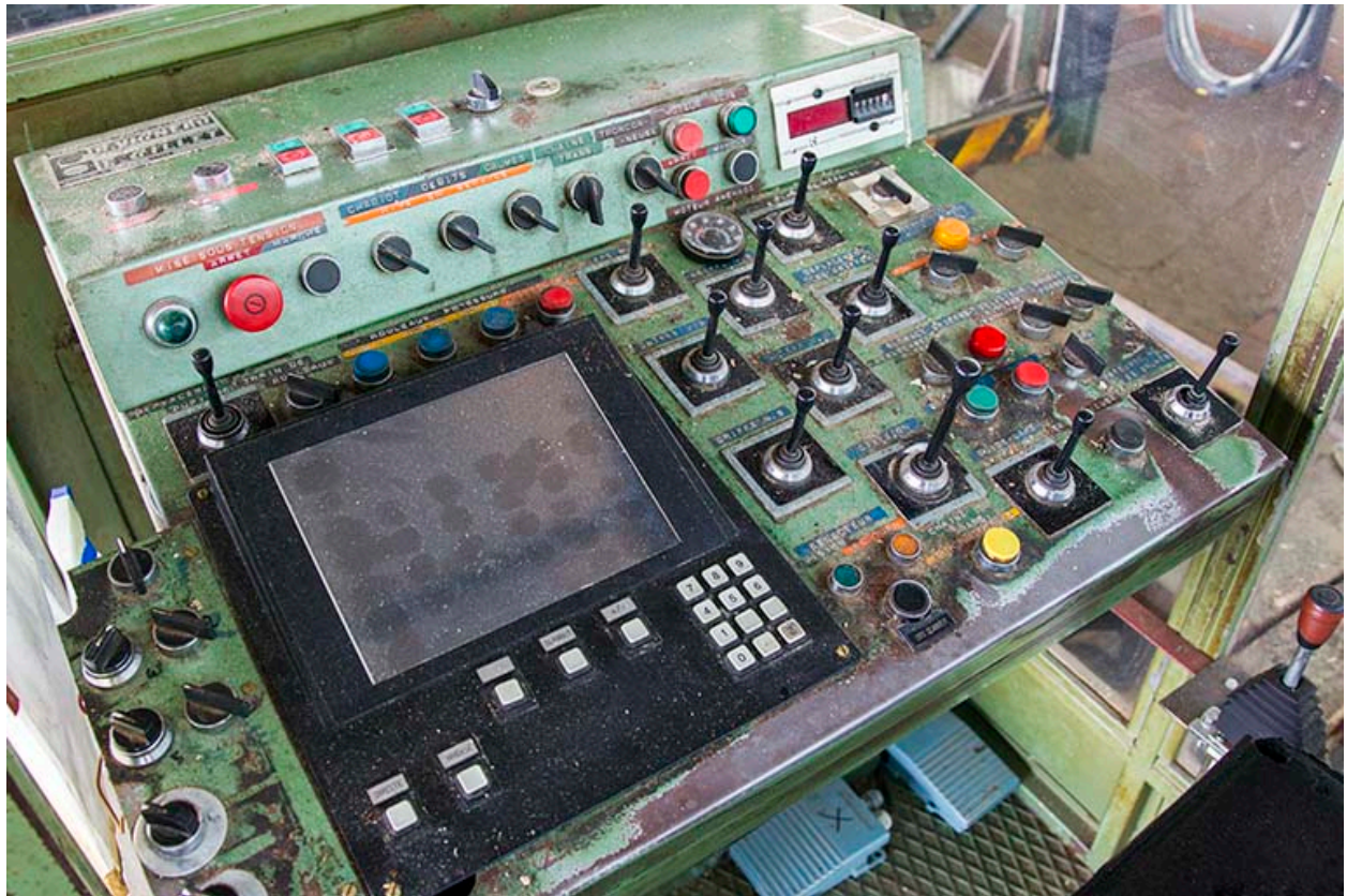
Scierie Filisetti, Cour-Saint-Maurice : pupitre du poste de commande de la scie Gillet et Vigneau.
