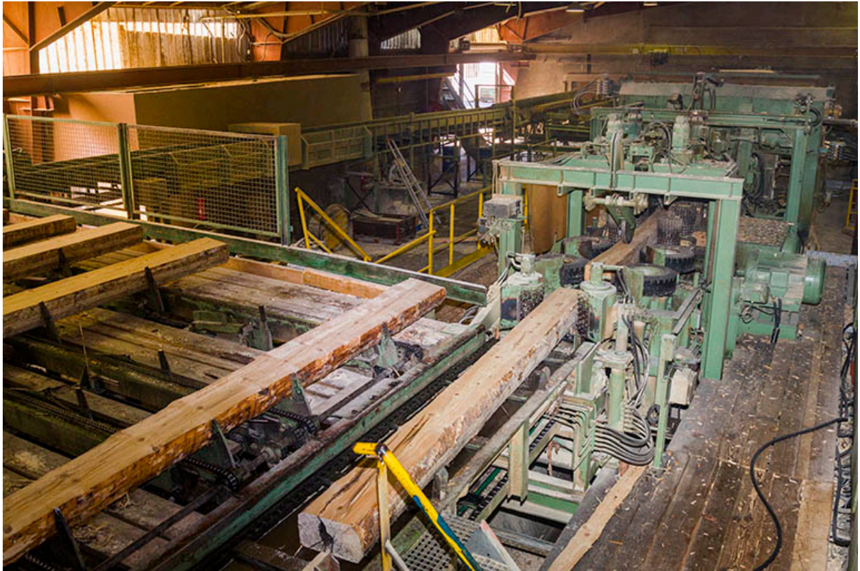
Scierie Thidric puis Gaume ou Grande Scierie mécanique de Maîche, Maîche : ligne "canter", pour les commandes destinées à la grande distribution.
