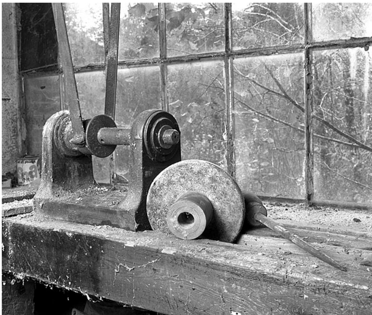
Usine de tabletterie (tournerie) Vuillermoz, Vulvoz (au Moulin) : tour à bois.
