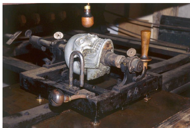
Machine à sculpter les têtes de pipes de l'atelier d'Olivier Racine, Saint-Claude (Etables) : modèle et son support. Phot. Jérôme Mongreville IVR43_20003901039ZA
