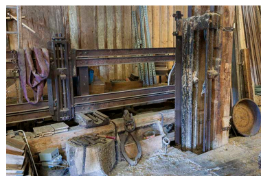
Scierie Thiébaud, Labergement- Sainte-Marie : châssis de scie monolame ("sabre"). Phot. Jérôme Mongreville IVR43_20162500438NUC4A
