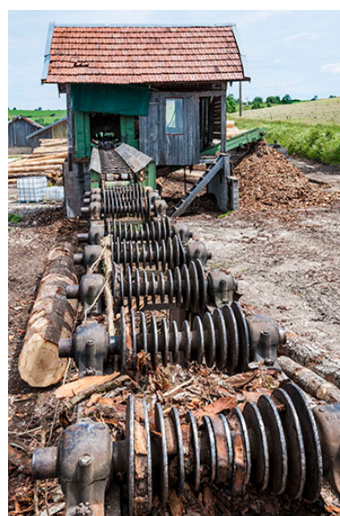
Scierie Faivre-Rampant, Guyans-Vennes : rouleaux d'entraînement du poste d'écorçage.
