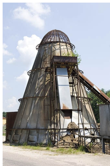
Scierie et menuiserie Detroye, Corre : four à écorces américain. Phot. Jérôme Mongreville IVR43_20097000716NUC2A
