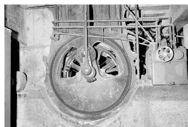
Usine de tournerie et scierie Janier-Vuillermoz, Lavans-lès- Saint-Claude (2-4 rue du Caton) : système d'entraînement du châssis de scie multilame Socolest. Phot. Laurent Poupard IVR43_19913900996Z
