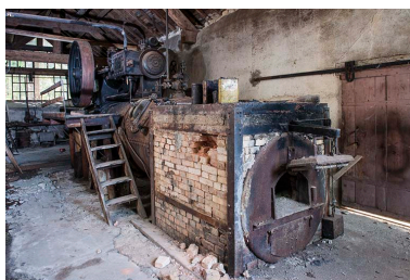
Scierie des Mortes, Chapelle-des-Bois (les Mortes) : machine à vapeur King. Phot. Jérôme Mongreville IVR43_20152501815NUC4A
