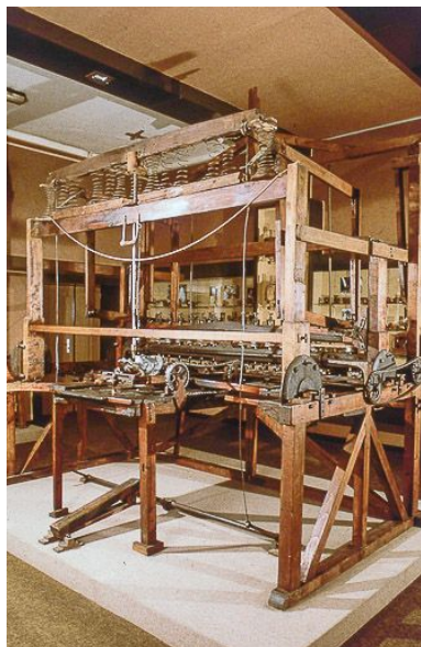
Exposition Pipes et Diamants, Saint-Claude : machine à sculpter les têtes de pipes. Phot. Jérôme Mongreville IVR43_20003901214ZA
