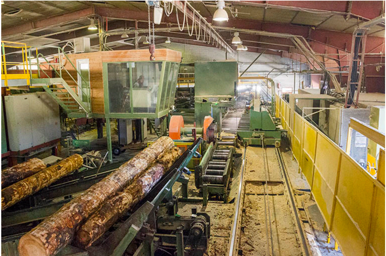
Scierie Thidric puis Gaume ou Grande Scierie mécanique de Maîche, Maîche : ligne ruban, pour les commandes diversifiées.
