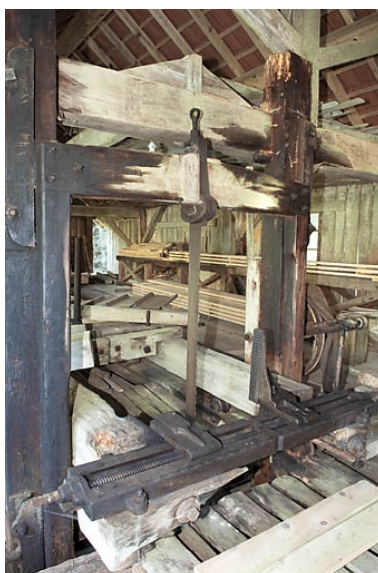
Scierie Lamboley, Miellin (le Miellenot) : châssis de scie monolame. Phot. Jérôme Mongreville IVR43_20077000623NUCA
