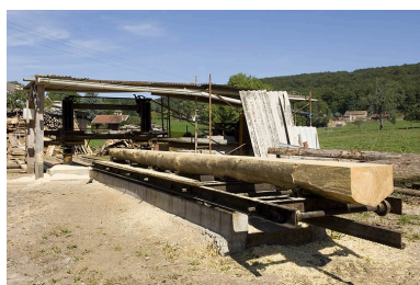
Moulin à farine puis scierie, Aillevillers-et-Lyaumont (hameau de la Louvière) : châssis de scie monolame horizontale. Phot. Jérôme Mongreville IVR43_20067000770NUCA
