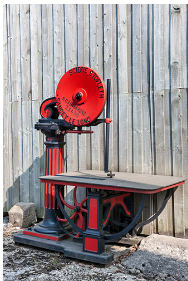
Moulin des Calots, actuellement scierie Stofleth, Sancey-le- Long : scie à ruban Perrin (Paris). Phot. Jérôme Mongreville IVR43_20152500421NUC4A
