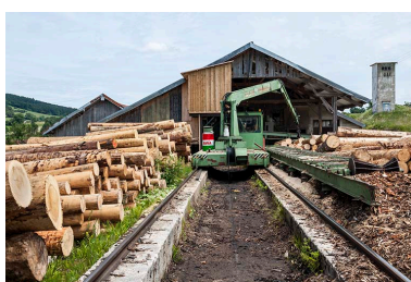
Scierie Faivre-Rampant, Guyans-Vennes : chariot de transport de grumes. Phot. Jérôme Mongreville IVR43_20152501476NUC4A
