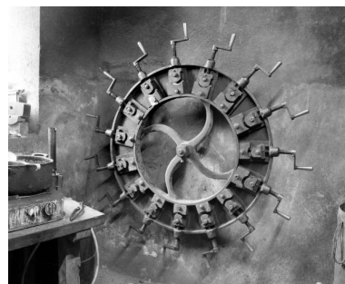
Usine de tabletterie (usine de pipes) Ropp puis Waille, Saint-Claude (5 rue Saint-Oyend, 51 bis rue de la Poyat) : machine à cintrer les tuyaux en corne. Phot. Jérôme Mongreville IVR43_19923900507X
