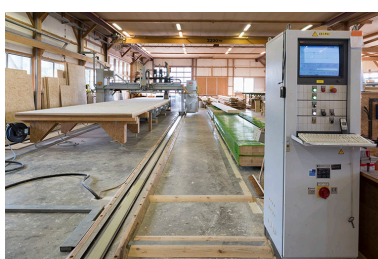
Usine de menuiserie Henri Vermot et Fils, Villers-le-Lac (unité 1 route des Fins) : pont multifonctions à commandes numériques Weinmann. Phot. Sonia Dourlot IVR43_20162501278NUC4A
