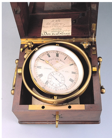
Cadran et système à cardans. Phot. Jérôme Mongreville IVR43_20032500704XA
