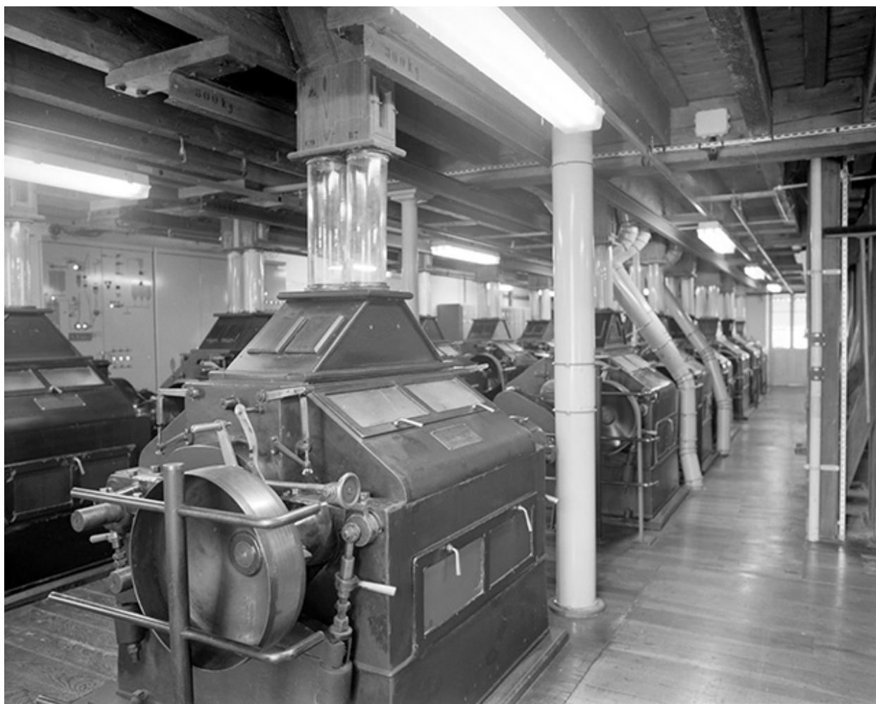
Atelier de fabrication (L), 1er étage : rangée d'appareils à cylindres.
