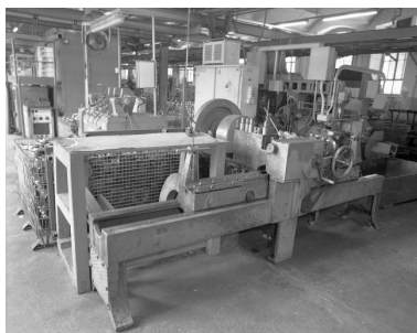
Redresseuse (atelier des fins de séries). Phot. Jérôme Mongreville IVR43_20022500421X
