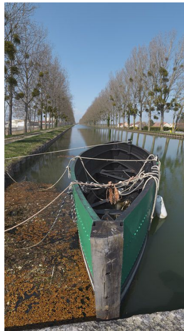
Bateau-écluse : ce bateau se glisse dans des rainures spécialement conçues à cette effet dans les bajoyers pour remplacer les portes en cas de travaux sur ces dernières. Phot. Thierry Kuntz IVR26_20112103107NUC4A
