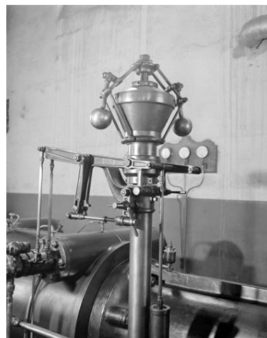
Salle des machines (10) : régulateur à boules de la machine à vapeur. Phot. Yves Sancey IVR43_19893900295X
