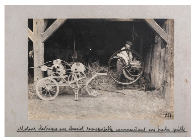
Moteur électrique sur chariot transportable commandant un hache paille, 1ère moitié 20e siècle. Phot. Sonia Dourlot IVR43_20209000060NUC4A
