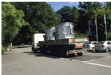
Camion chargé de deux poches d'aluminium liquide. Phot. Yves Sancey IVR43_20019000431ZA
