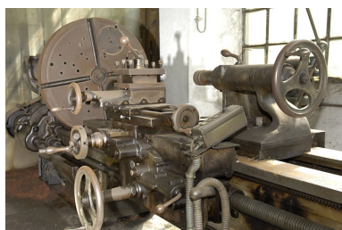
machine à tourner (tour à chariotier et à fileter) : détail du chariot. Phot. Jérôme Mongreville IVR43_20057000211NUCA
