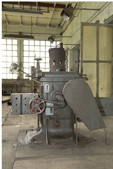
1ère machine à usiner par outil de coupe (étau-limeur) : vue de profil Phot. Jérôme Mongreville IVR43_20057000209NUCA
