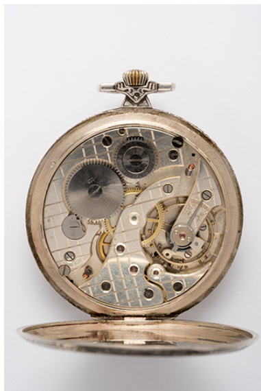
Mouvement Parrenin : calibre HP 18,5 U. Phot. Sonia Dourlot IVR43_20162500353NUC4A
