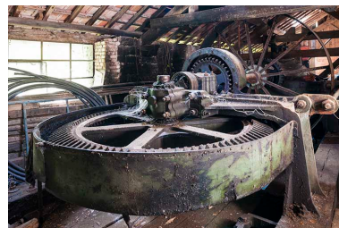
Bâtiment d'eau. Vestiges de la transmission de la centrale hydroélectrique. Phot. Jérôme Mongreville IVR43_20152501626NUC4A
