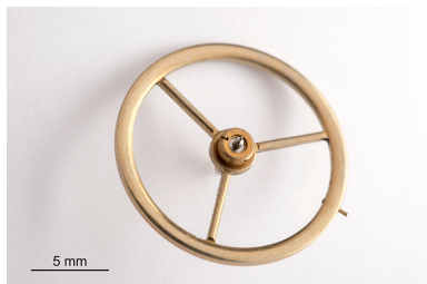
Exemple de balancier tel que Fallet pouvait en produire. Dans ce balancier, appelé " dardaine ", la serge (jante) et les bras sont arrondis et polis. Phot. Sonia Dourlot IVR43_20152500011NUC4A
