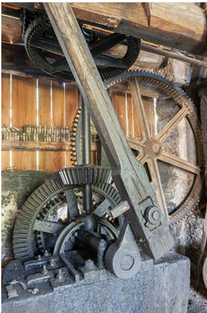
Mécanisme de transmission par bielle.
