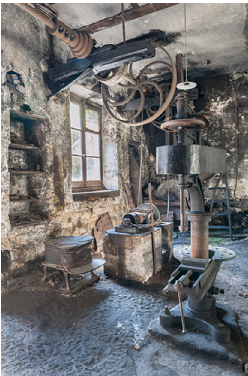
Atelier de mécanique : transmission aérienne, poêle, polissoir et perceuse à colonne.
