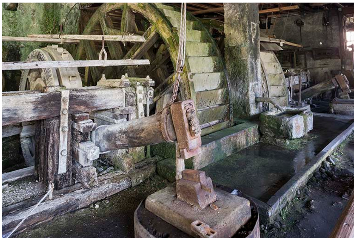
Les martinets et leurs roues motrices.
