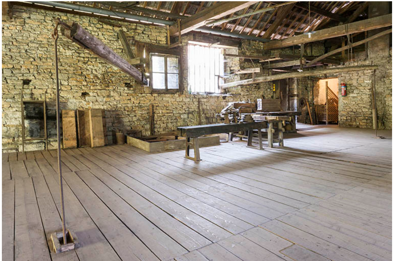
Etage supérieur de l'atelier de forge. A gauche, tige et bras de commande pour l'admission de l'eau sur les roues des martinets.
