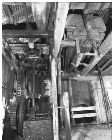
Vue d'un soufflet et du mécanisme. Phot. Yves Sancey
