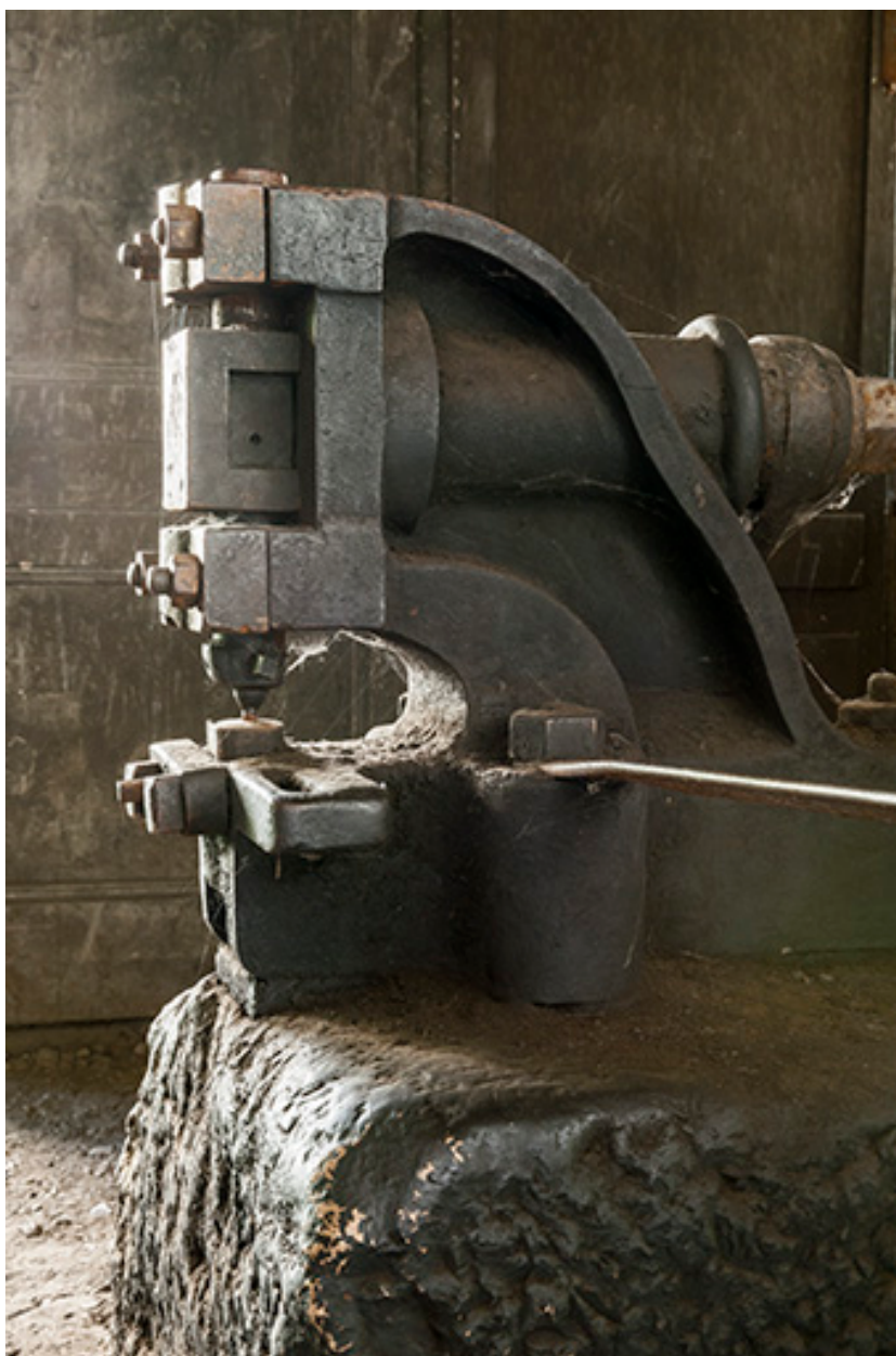
Atelier de mécanique. Poinçonneuse vue de côté.
