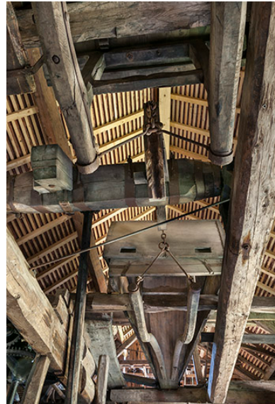
Mécanisme de bascule du soufflet double (caisson sud en position haute). Phot. Jérôme Mongreville IVR43_20152501575NUC4A
