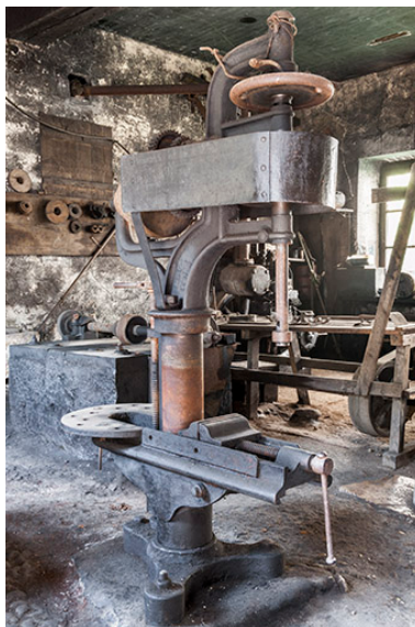
Atelier de mécanique. Perceuse à colonne. Phot. Jérôme Mongreville IVR43_20152501550NUC4A
