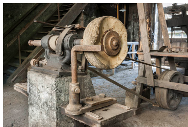
Poste de polissage. Détail des disques de coton. Phot. Jérôme Mongreville IVR43_20152501560NUC4A
