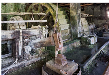
Les martinets et leurs roues motrices. Phot. Jérôme Mongreville IVR43_20152501535NUC4A
