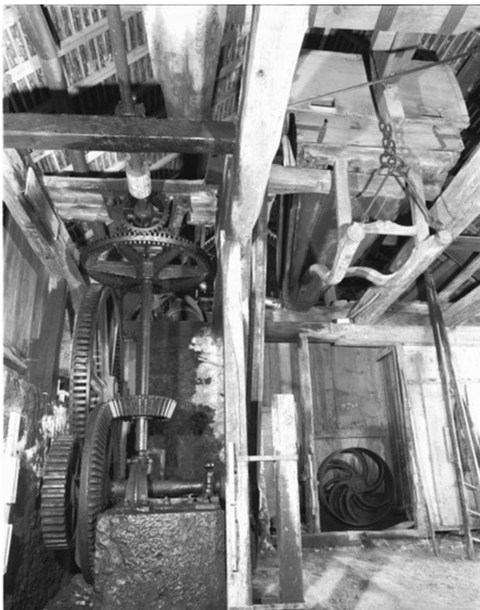
Vue d'un soufflet et du mécanisme.
