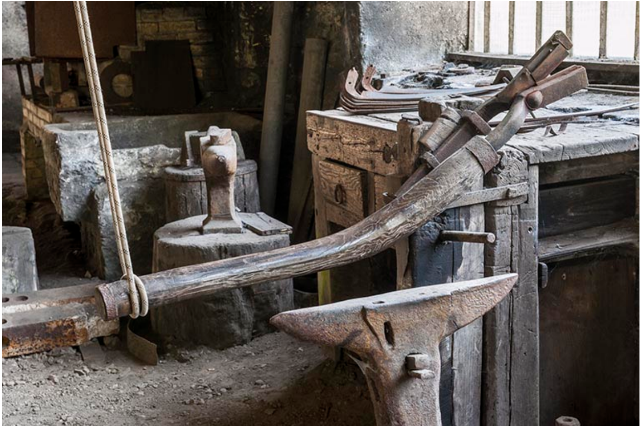
Cisaillon de fabrication "maison". Reliée via une corde par une perche de noisetier fixée au plafond, elle est actionnée par le poids de l'ouvrier, assis en amazone sur le manche.
