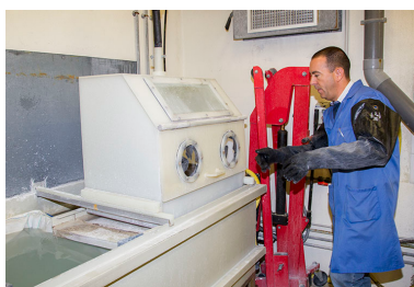
Fonte à la cire perdue : préparation pour le nettoyage des arbres en métal à l'aide d'eau sous pression.
