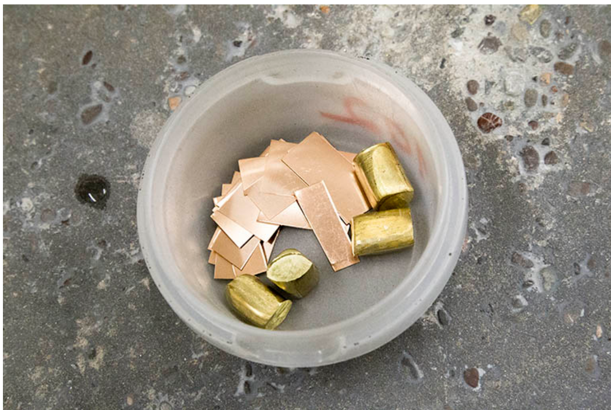
Fonte à la cire perdue : préparation du métal (laiton) pour la fonte.
