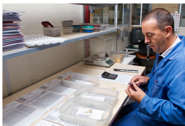
Fonte à la cire perdue : vérification du diamètre d'une alliance. Phot. Yves Sancey IVR43_20132502882NUC2A
