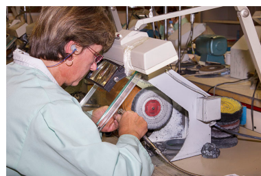
Atelier de polissage : polissage d'une alliance. Phot. Yves Sancey IVR43_20132502888NUC2A
