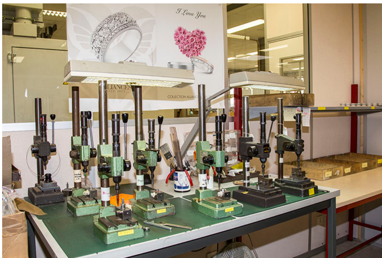
Atelier de poinçonnage : machines à poinçonner.
