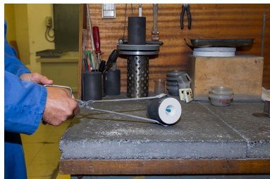
Fonte à la cire perdue : moule réfractaire avant cuisson. Le cylindre bleu correspond au tronc de l'arbre et réserve l'emplacement du conduit d'alimentation.
