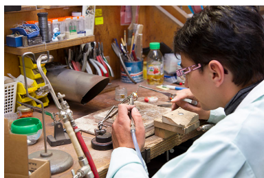
Atelier de finition et réparation : mise à dimension d'une alliance. Phot. Yves Sancey IVR43_20132502841NUC2A
