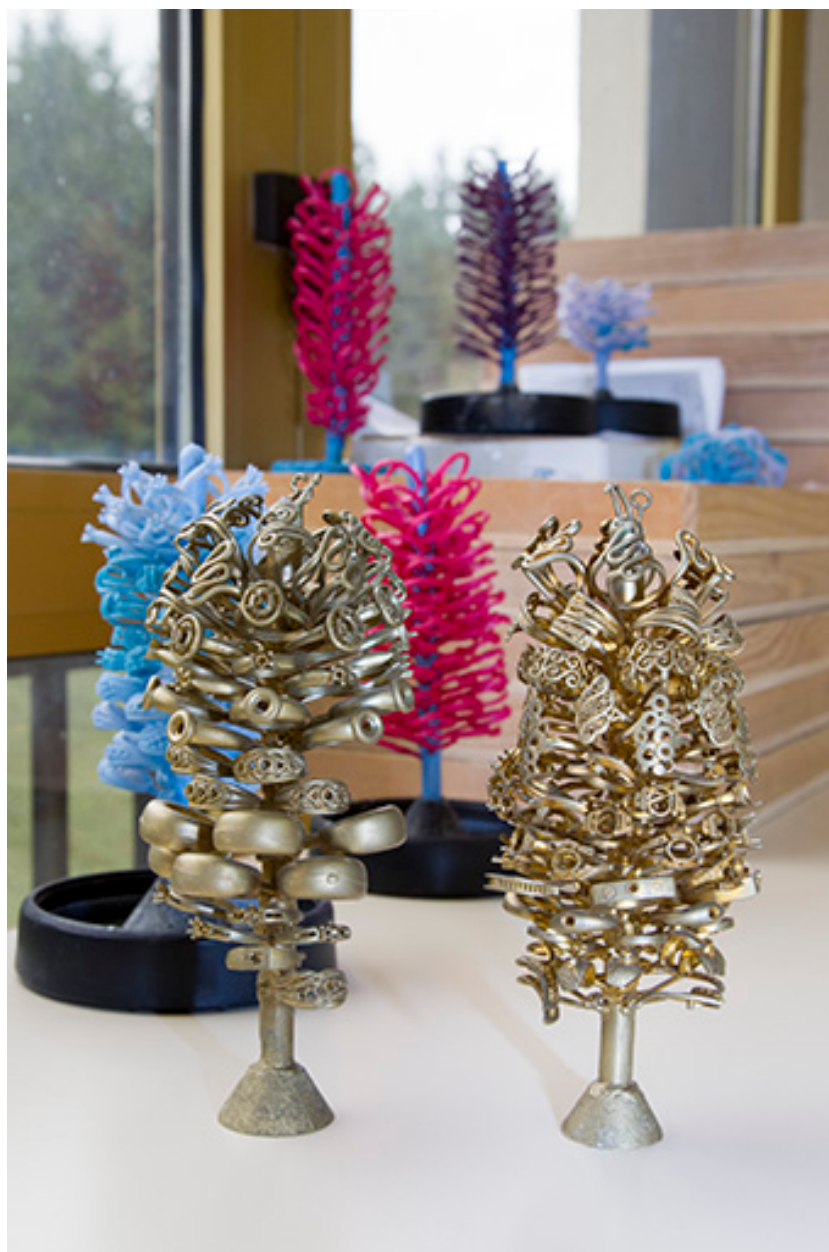
Fonte à la cire perdue : arbres en cire et arbres en métal, après la fonte.
