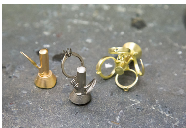
Fonte à la cire perdue : les arbres en métal. Phot. Yves Sancey IVR43_20132502880NUC2A
