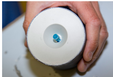
Fonte à la cire perdue : moule réfractaire (plâtre de bijouterie coulé dans un cylindre autour d'un arbre en cire).
