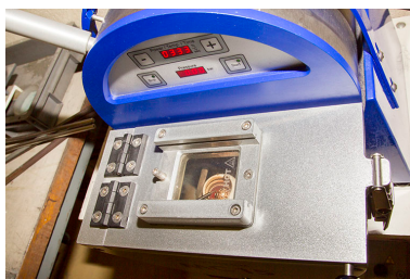
Fonte à la cire perdue : début de chauffage du métal.
