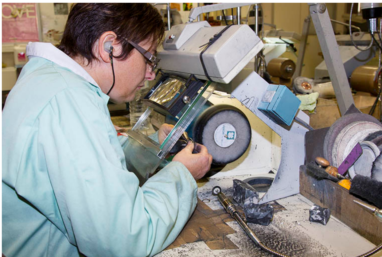
Atelier de polissage : polissage d'une alliance.
