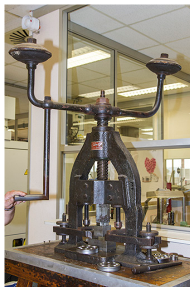
Usinage : presse à balancier désaffectée de la maison parisienne Gaston et Henri Venot. Phot. Yves Sancey IVR43_20132502926NUC2A
