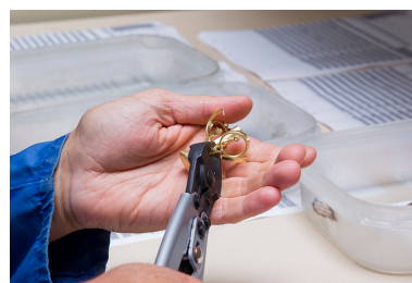
Fonte à la cire perdue : découpage des conduits d'alimentation (séparation des bijoux et de l'arbre). Phot. Yves Sancey IVR43_20132502881NUC2A
