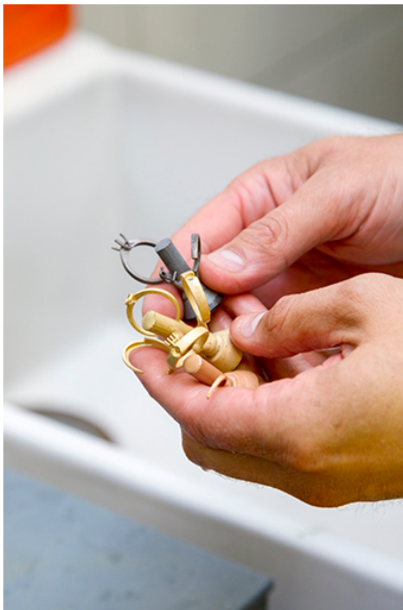
Fonte à la cire perdue : les arbres en métal nettoyés.
