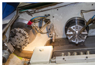
Usinage : support de la rondelle dans le 2e tour.
