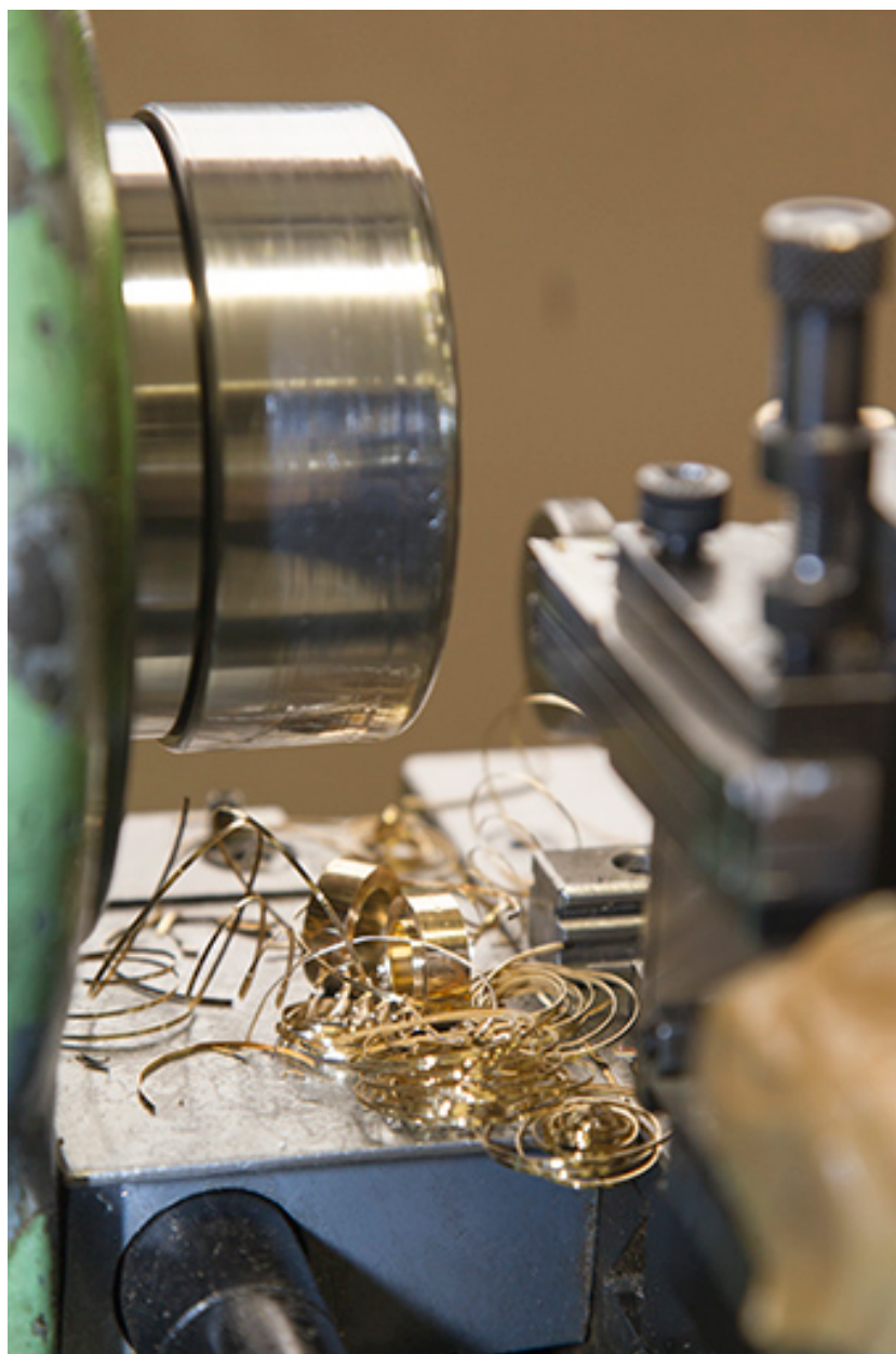
Usinage : copeaux issus de la découpe d'un tube.
