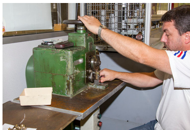
Usinage : laminage de la " rondelle " obtenue par la découpe du tube.
