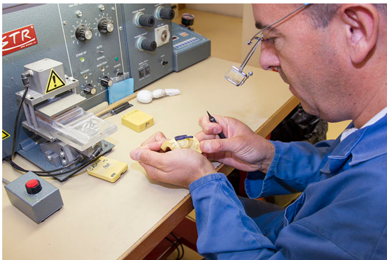
Fonte à la cire perdue : démoulage du tirage en cire.
