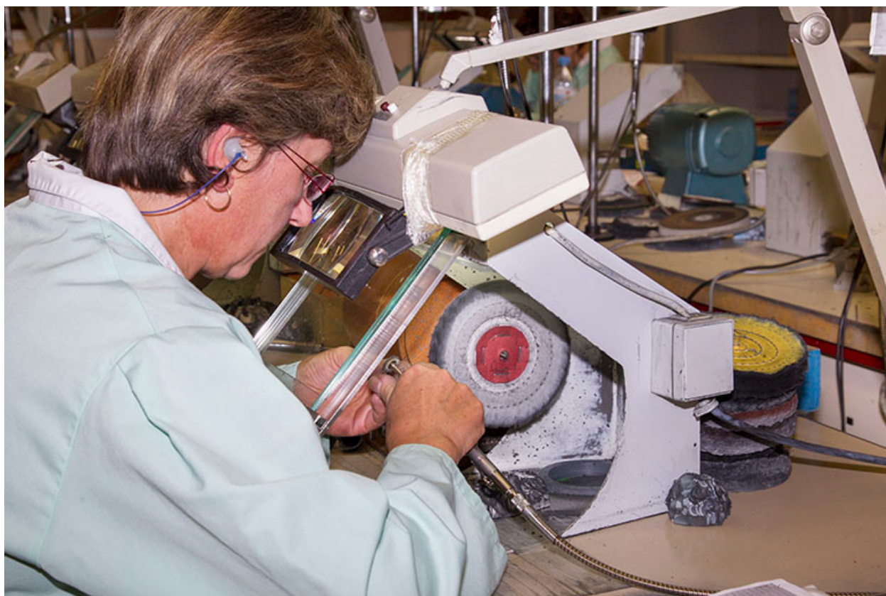
Atelier de polissage : polissage d'une alliance.
