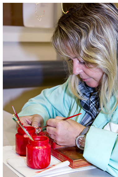
Atelier de traitement de surface : préparation d'une alliance (application de vernis rouge aux endroits qui seront épargnés). Phot. Yves Sancey IVR43_20132502894NUC2A
