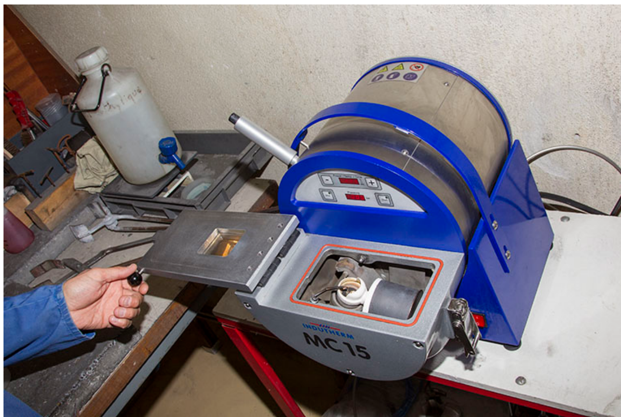
Fonte à la cire perdue : fermeture du four.
