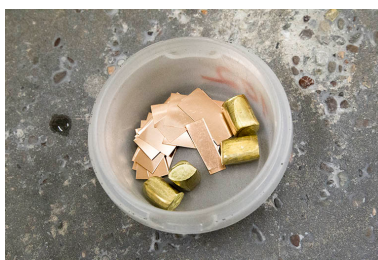
Fonte à la cire perdue : préparation du métal (laiton) pour la fonte.
