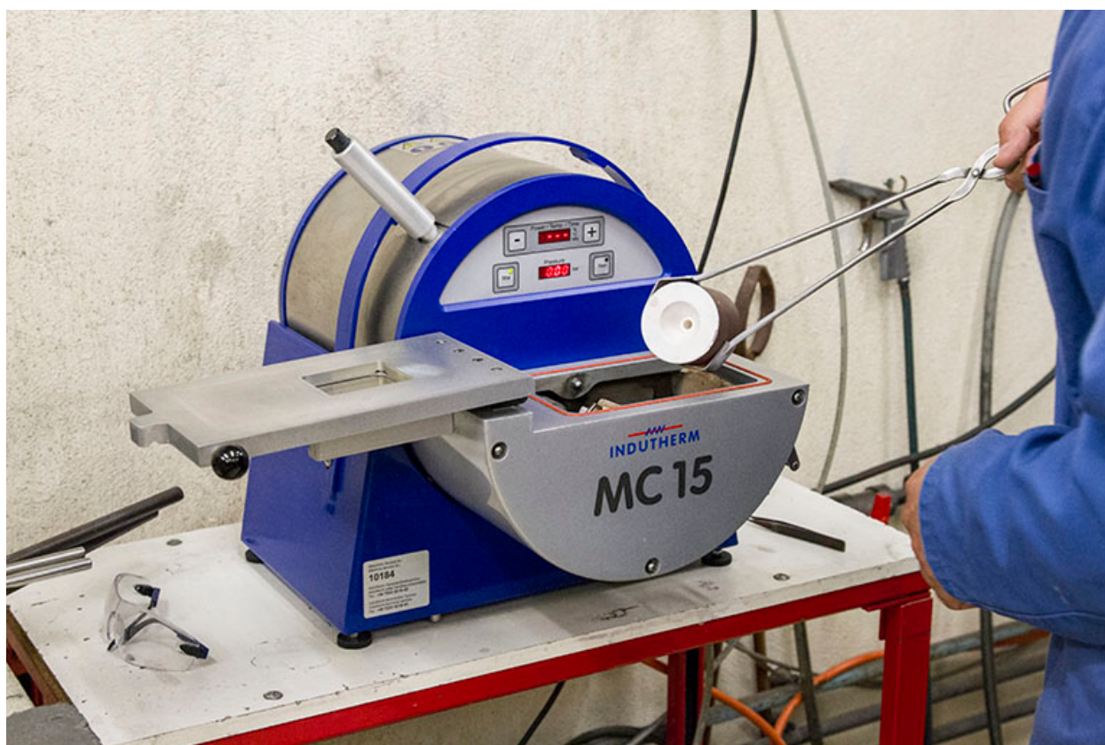
Fonte à la cire perdue : mise en place du moule dans le four.
