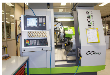
Usinage : 3e tour à commande numérique.
