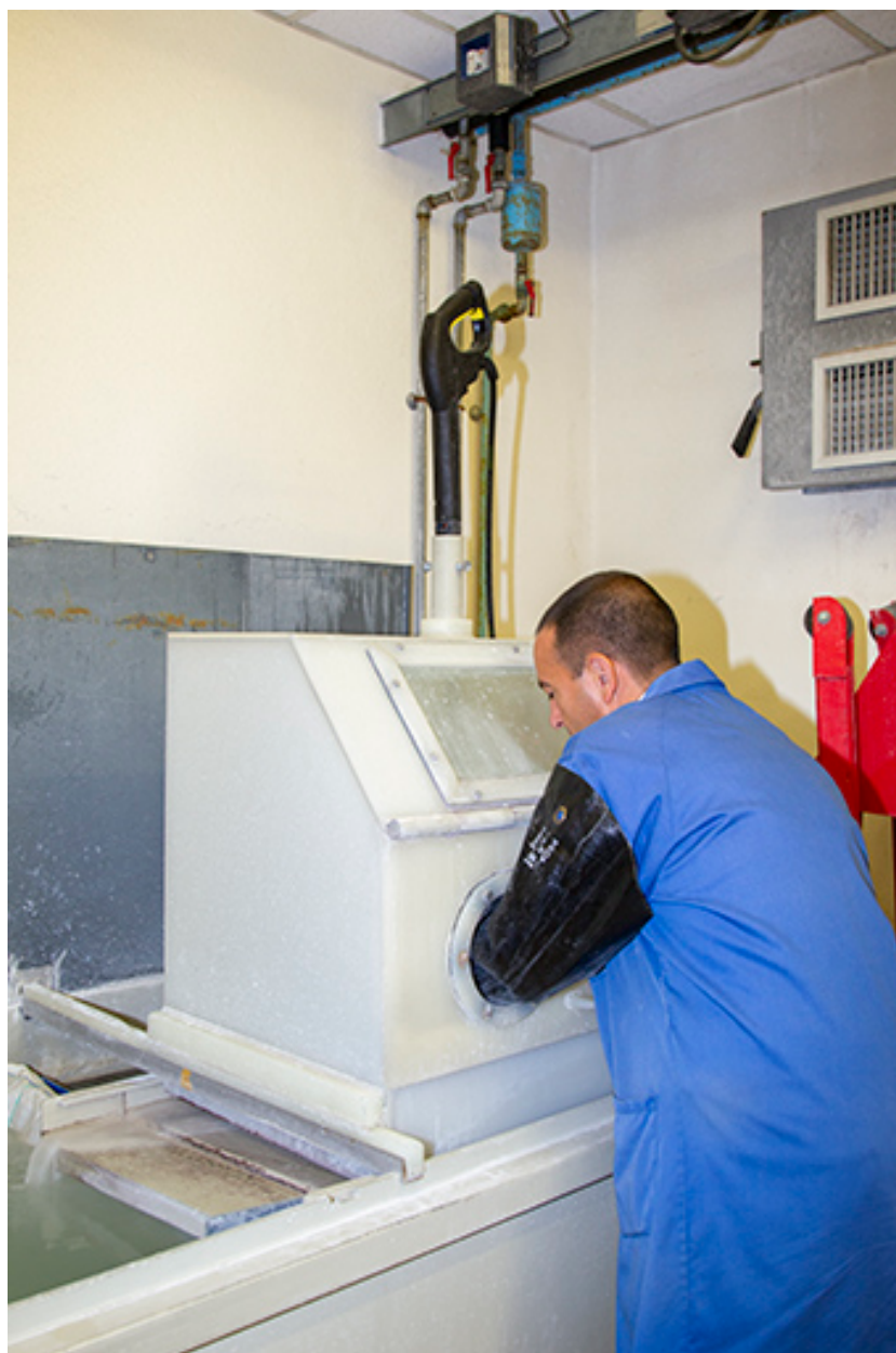
Fonte à la cire perdue : nettoyage des arbres en métal à l'aide d'eau sous pression.
