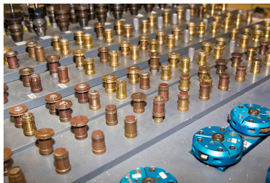
Usinage : fraises et mandrins de la machine à facetter.
