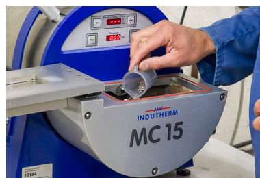
Fonte à la cire perdue : versement du métal (argent) dans le creuset.
