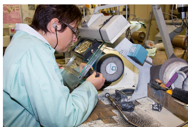
Atelier de polissage : polissage d'une alliance. Phot. Yves Sancey IVR43_20132502890NUC2A
