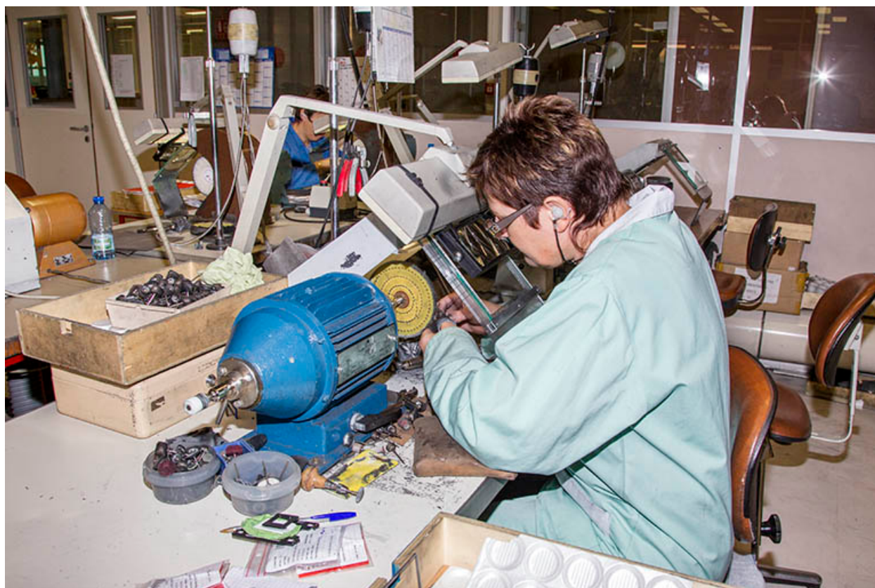
Atelier de polissage : polissage d'une alliance.
