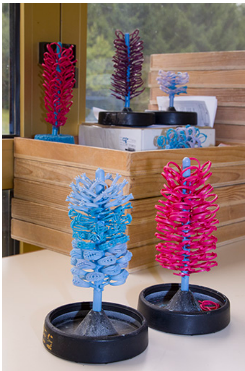
Fonte à la cire perdue : plusieurs arbres en cire.
