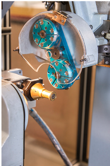
Usinage : fraises du module de gauche de la machine.
