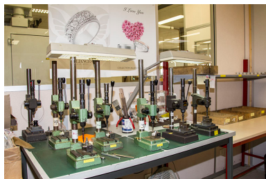
Atelier de poinçonnage : machines à poinçonner.
