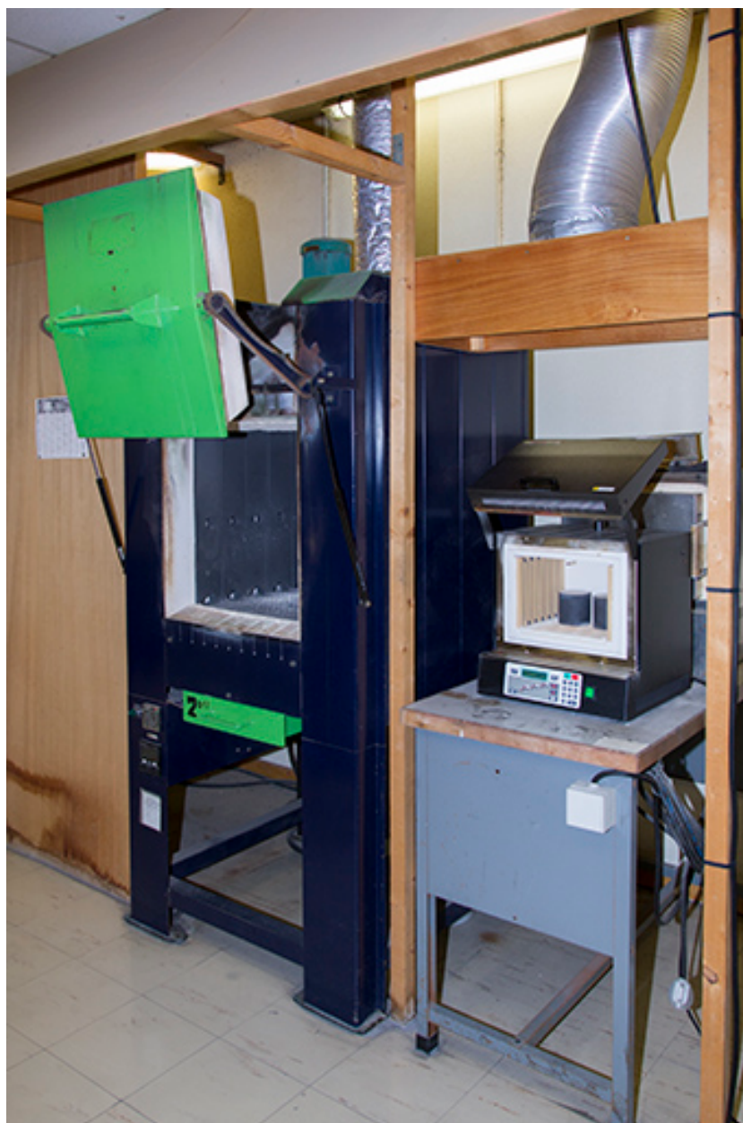
Fonte à la cire perdue : fours pour la cuisson des moules réfractaires.
