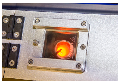
Fonte à la cire perdue : métal en fusion dans le creuset.
