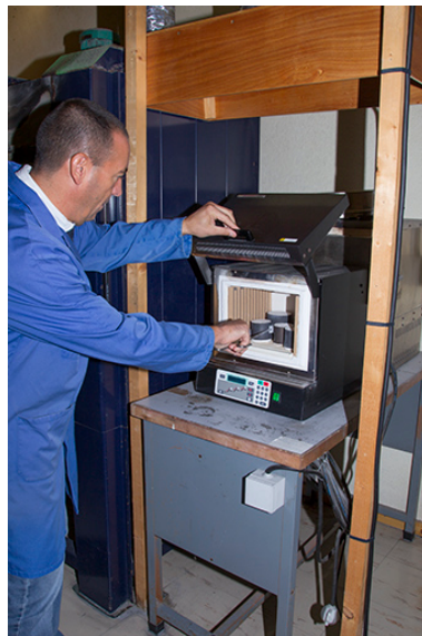
Fonte à la cire perdue : cuisson des moules réfractaires.
