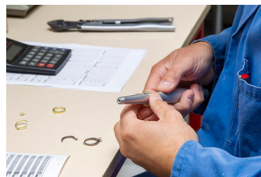
Fonte à la cire perdue : vérification du diamètre d'une alliance. Phot. Yves Sancey IVR43_20132502883NUC2A
