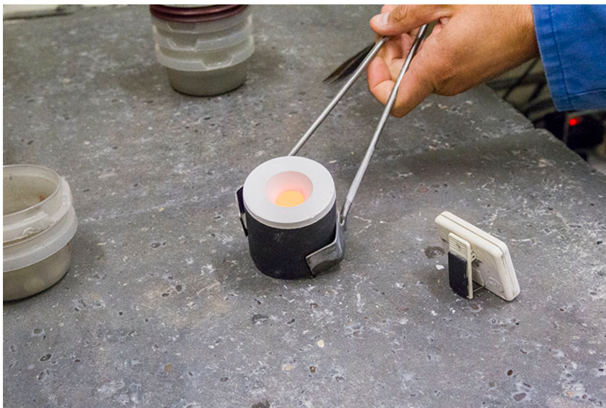
Fonte à la cire perdue : le moule rempli de métal en fusion.
