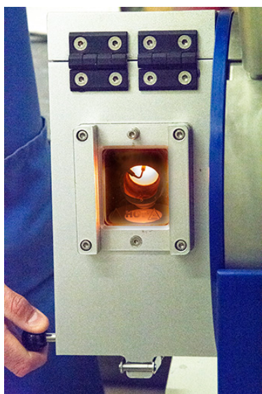
Fonte à la cire perdue : le métal fondu s'écoule du creuset dans le moule.
