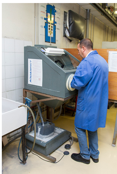
Fonte à la cire perdue : nettoyage des arbres en métal à l'aide de microbilles métalliques.
