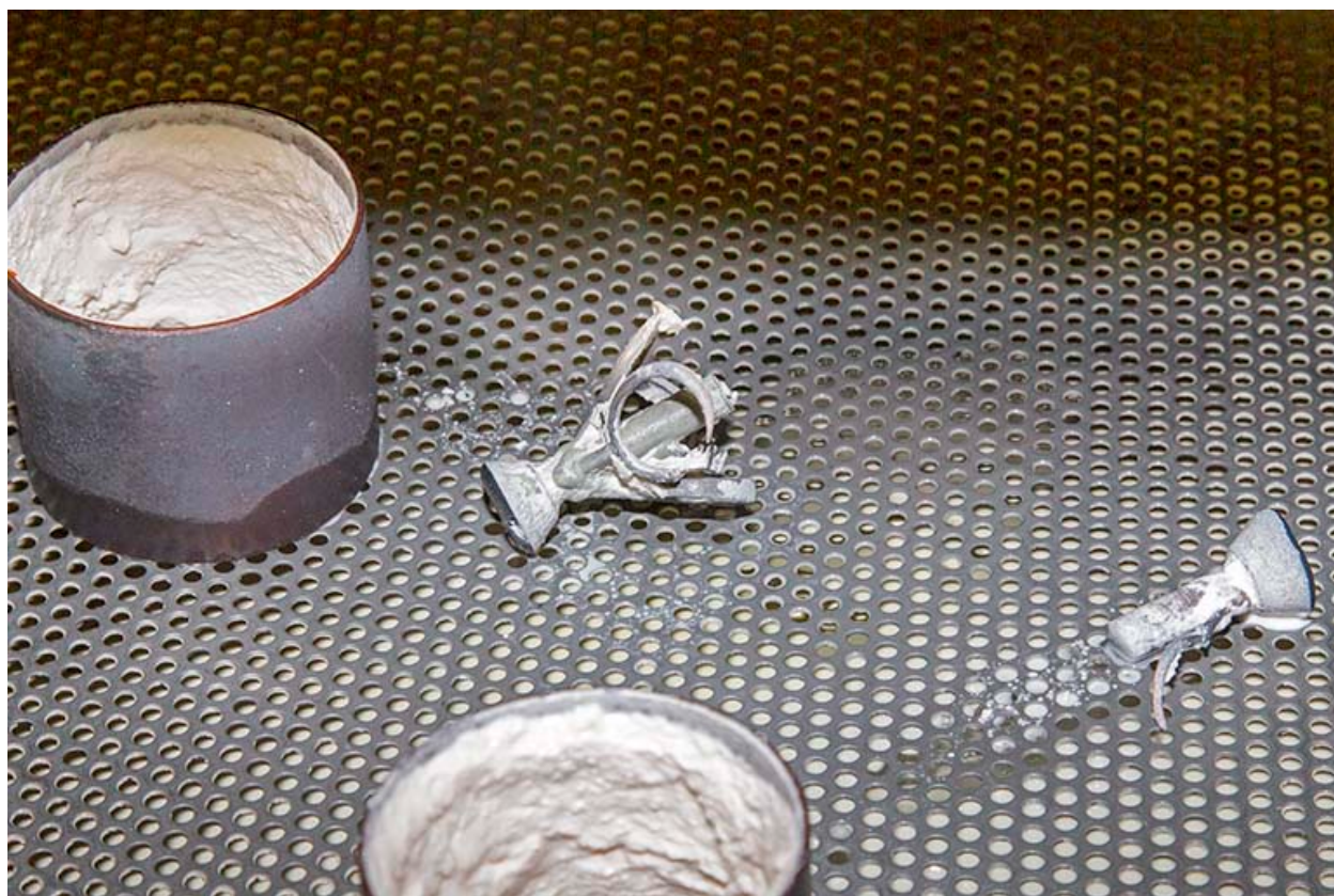
Fonte à la cire perdue : les arbres en métal au sortir du trempage du moule.
