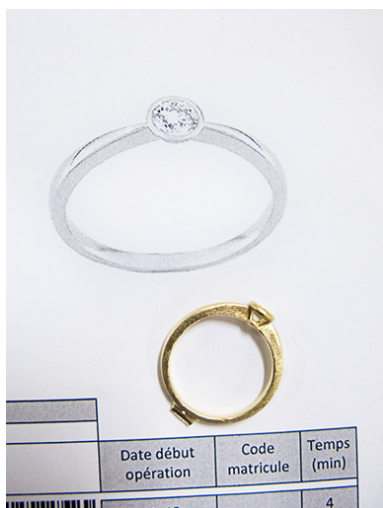
Fonte à la cire perdue : alliance sur sa fiche de fabrication. Phot. Yves Sancey IVR43_20132502885NUC2A
