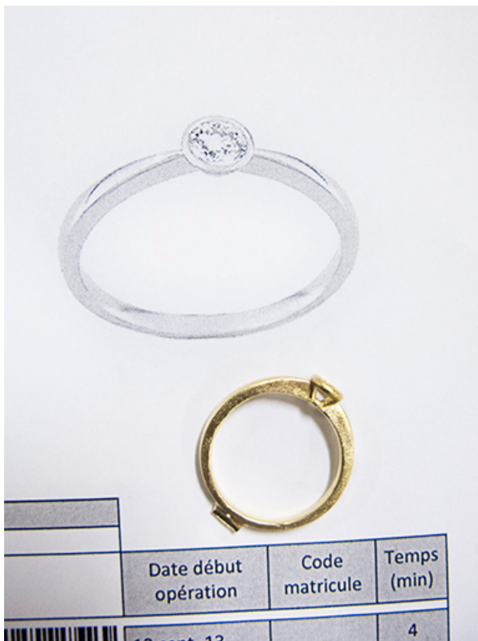
Fonte à la cire perdue : alliance sur sa fiche de fabrication.
