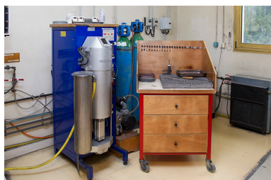
Fonte à la cire perdue : l'un des postes de travail pour la fonte des métaux.
