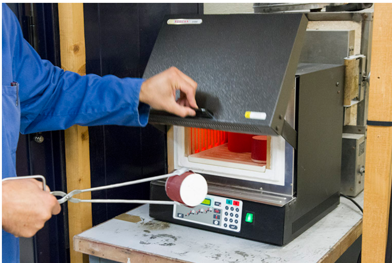
Fonte à la cire perdue : cuisson des moules réfractaires.
