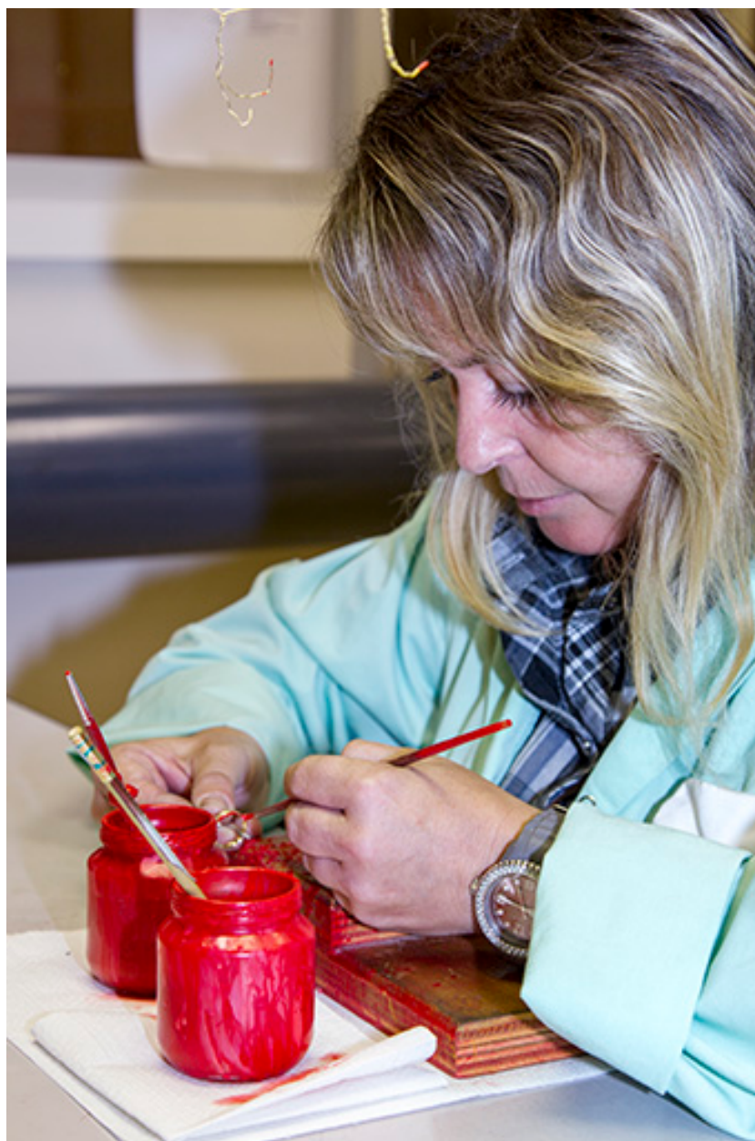
Atelier de traitement de surface : préparation d'une alliance (application de vernis rouge aux endroits qui seront épargnés).
