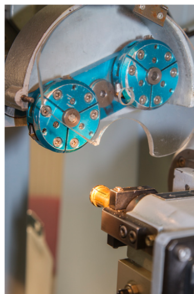
Usinage : fraises du module de gauche de la machine à facetter.
