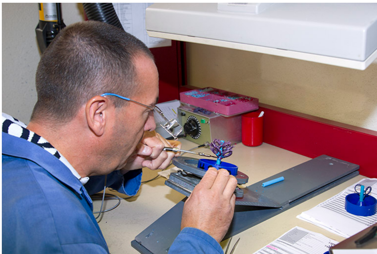
Fonte à la cire perdue : soudage du tirage en cire pour former un arbre.
