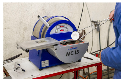
Fonte à la cire perdue : mise en place du moule dans le four.
