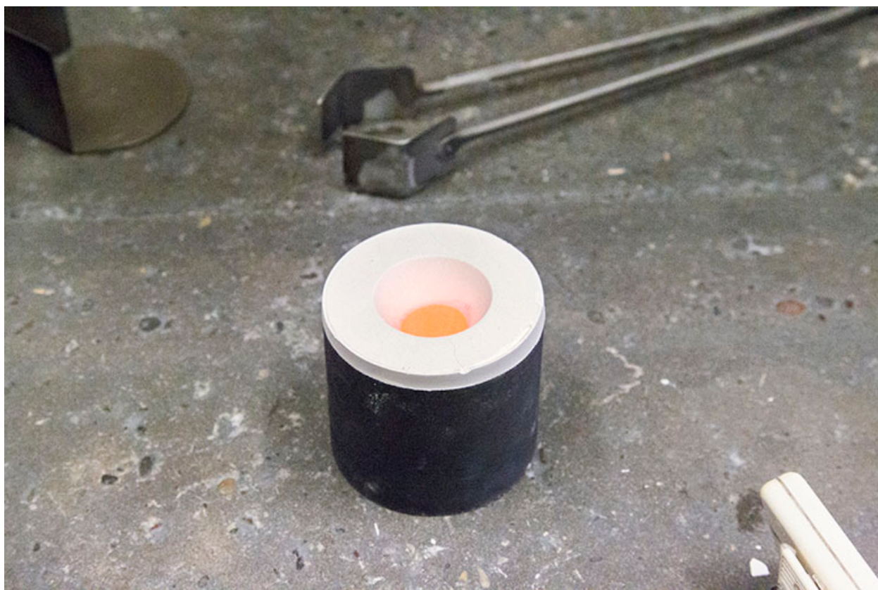
Fonte à la cire perdue : le moule rempli de métal en fusion (vue rapprochée).
