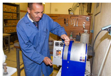
Fonte à la cire perdue : basculement du creuset pour alimenter le moule en métal fondu.
