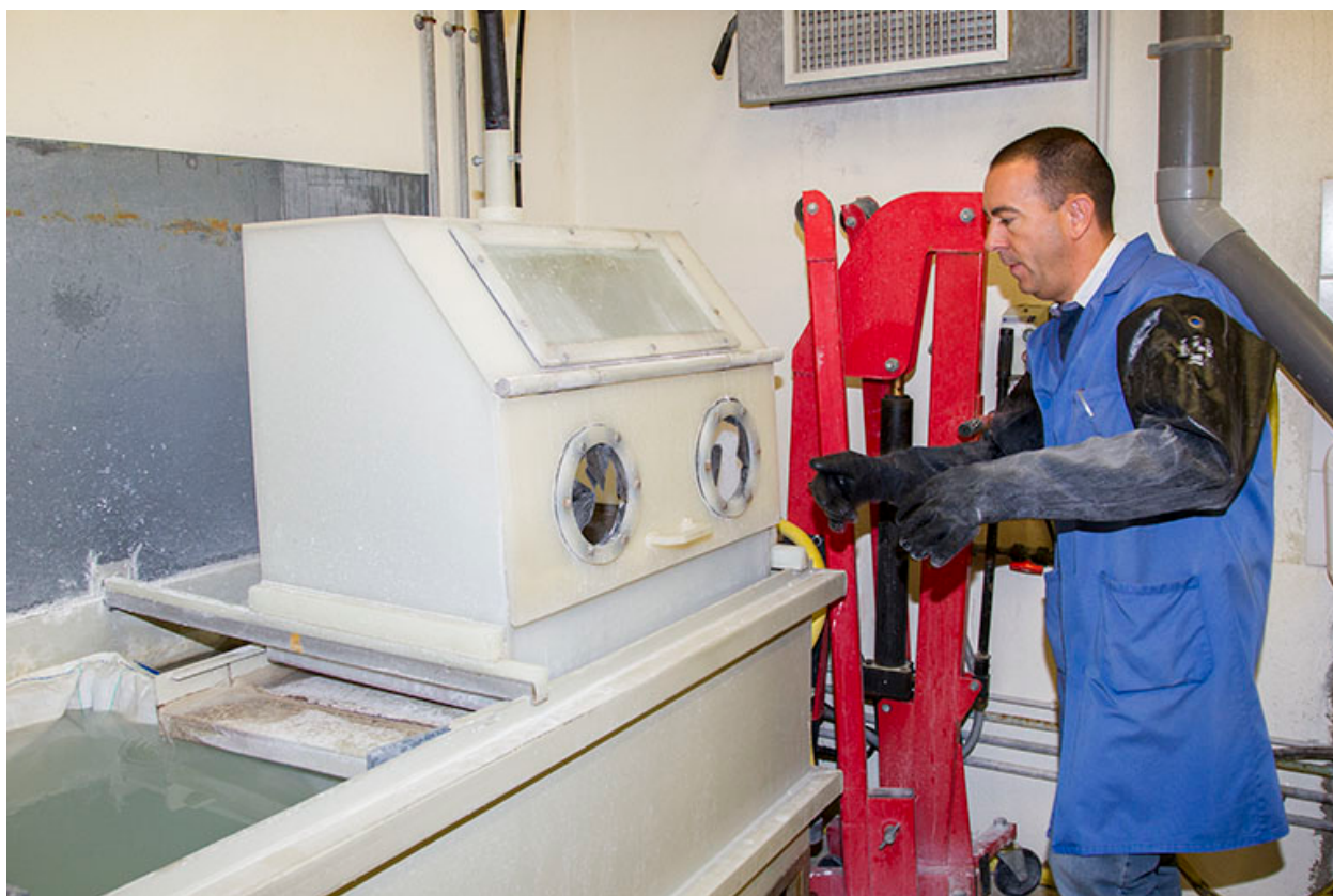
Fonte à la cire perdue : préparation pour le nettoyage des arbres en métal à l'aide d'eau sous pression.
