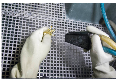
Fonte à la cire perdue : nettoyage des arbres en métal à l'aide de microbilles métalliques.
