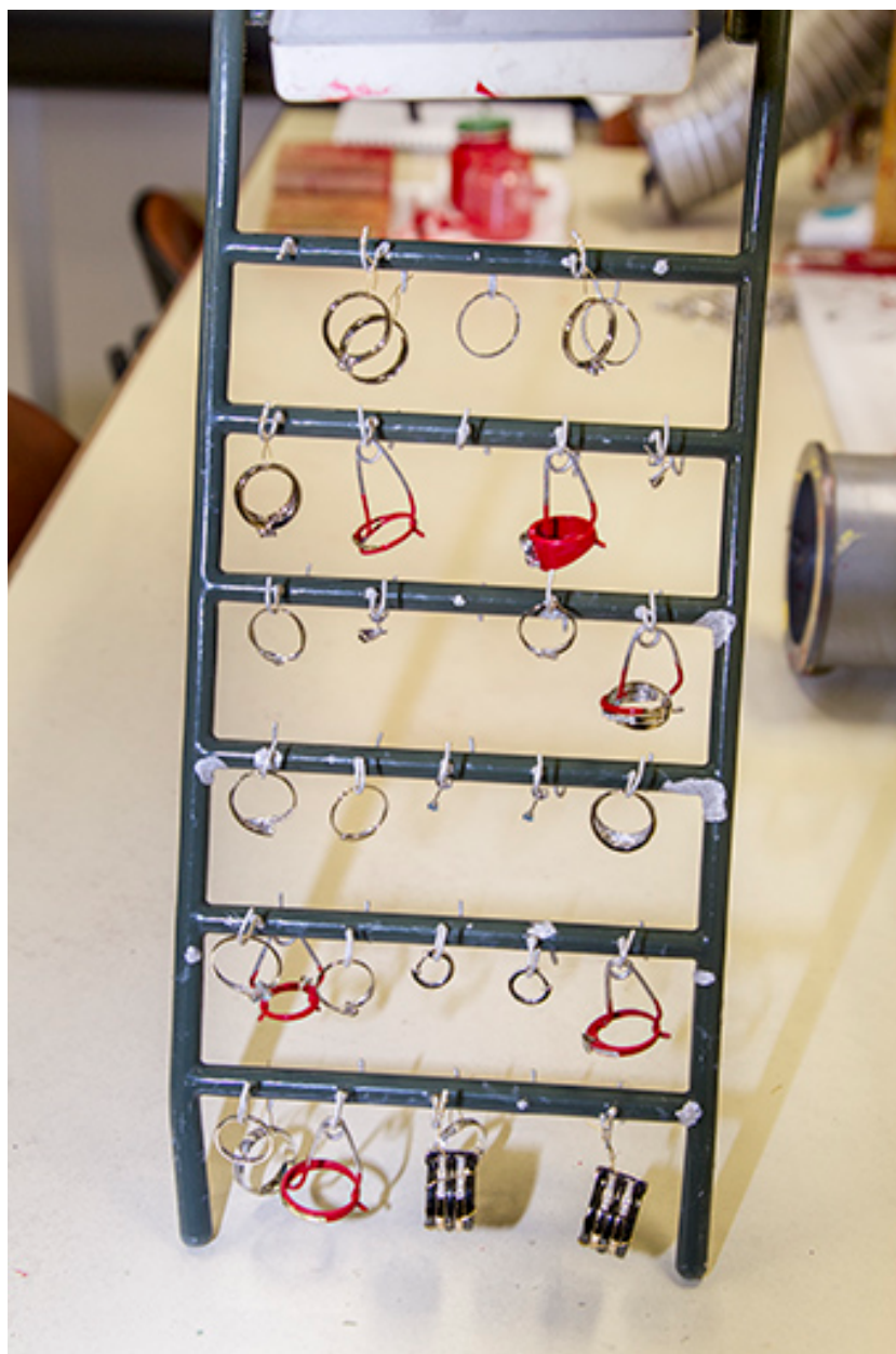
Atelier de traitement de surface : bouclard portant des alliances avant passage dans les bains galvanoplastiques.
