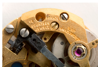
Mouvement Lip RE 50 : inscriptions côté ponts. Phot. Sonia Dourlot IVR43_20152502566NUC4A
