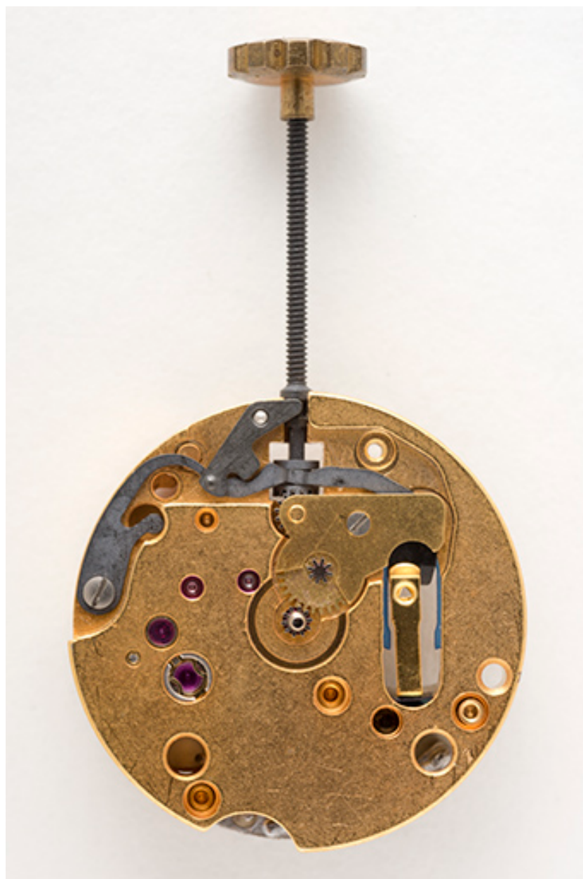
Mouvement Lip RE 50, vu côté cadran.
