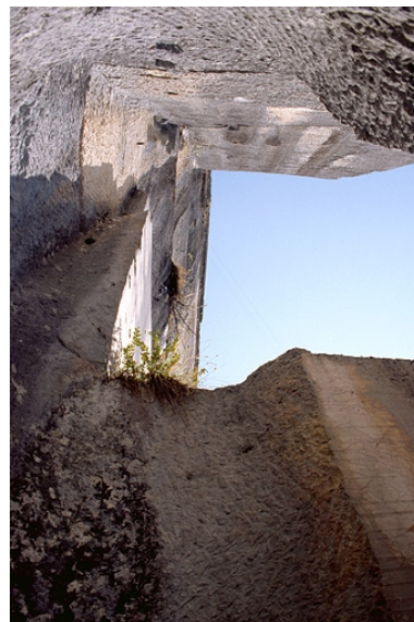
Carrière, partie nord : tranchée et puits pour le passage du fil hélicoïdal, vus du dessous. Phot. Yves Sancey IVR43_19973900125ZA
