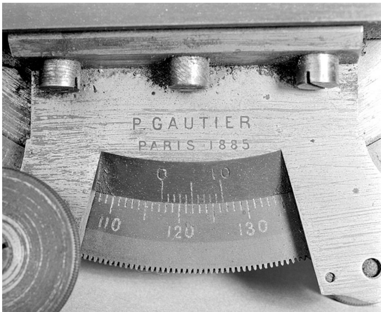
Le cercle gradué, avec la vis tangente à double graduation et les inscriptions concernant le fabricant.
