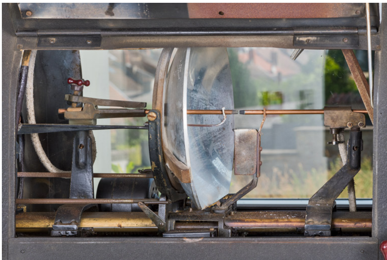
1er projecteur Etoile Film : lanterne avec sa lampe à arc.
