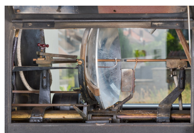
1er projecteur Etoile Film : lanterne avec sa lampe à arc. Phot. Pierre-Marie Barbe-Richaud IVR26_20257100701NUC4A
