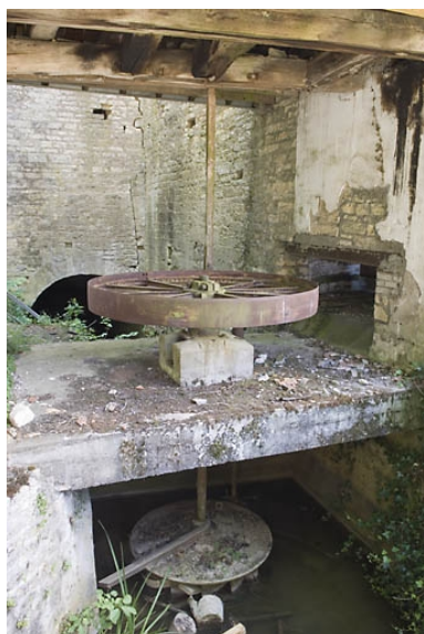
Bâtiment d'eau. Turbine hydraulique et éléments de transmission. Phot. Jérôme Mongreville IVR43_20087000709NUC2A
