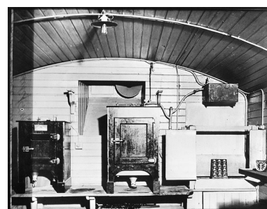
Epreuves thermiques. Etuves. Températures constantes de 40° et 15°, entre 1932 et 1934.
