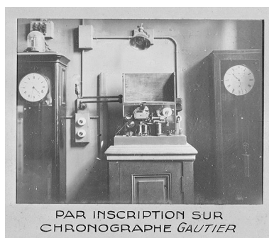
[Comparaison des montres] par inscription sur chronographe Gautier [...], entre 1932 et 1934. Chronographe Prin et non Gautier comme l'indique la légende (entre les pendules Leroy 1157, à gauche, et Fénon n° 115).
