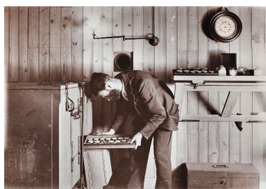
[Test thermique des montres par Auguste Hérique, utilisant le meuble-glacière conçu par Paul Chofardet], 1er quart 20e siècle. Autr. Jacques Boyer, Phot. Yves Sancey IVR43_20072500645NUCA
