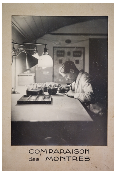
[Comparaison des montres] par inscription sur chronographe Gautier [...], entre 1932 et 1934. Chronographe Prin et non Gautier comme l'indique la légende (entre les pendules Leroy 1157, à gauche, et Fénon n° 115).
