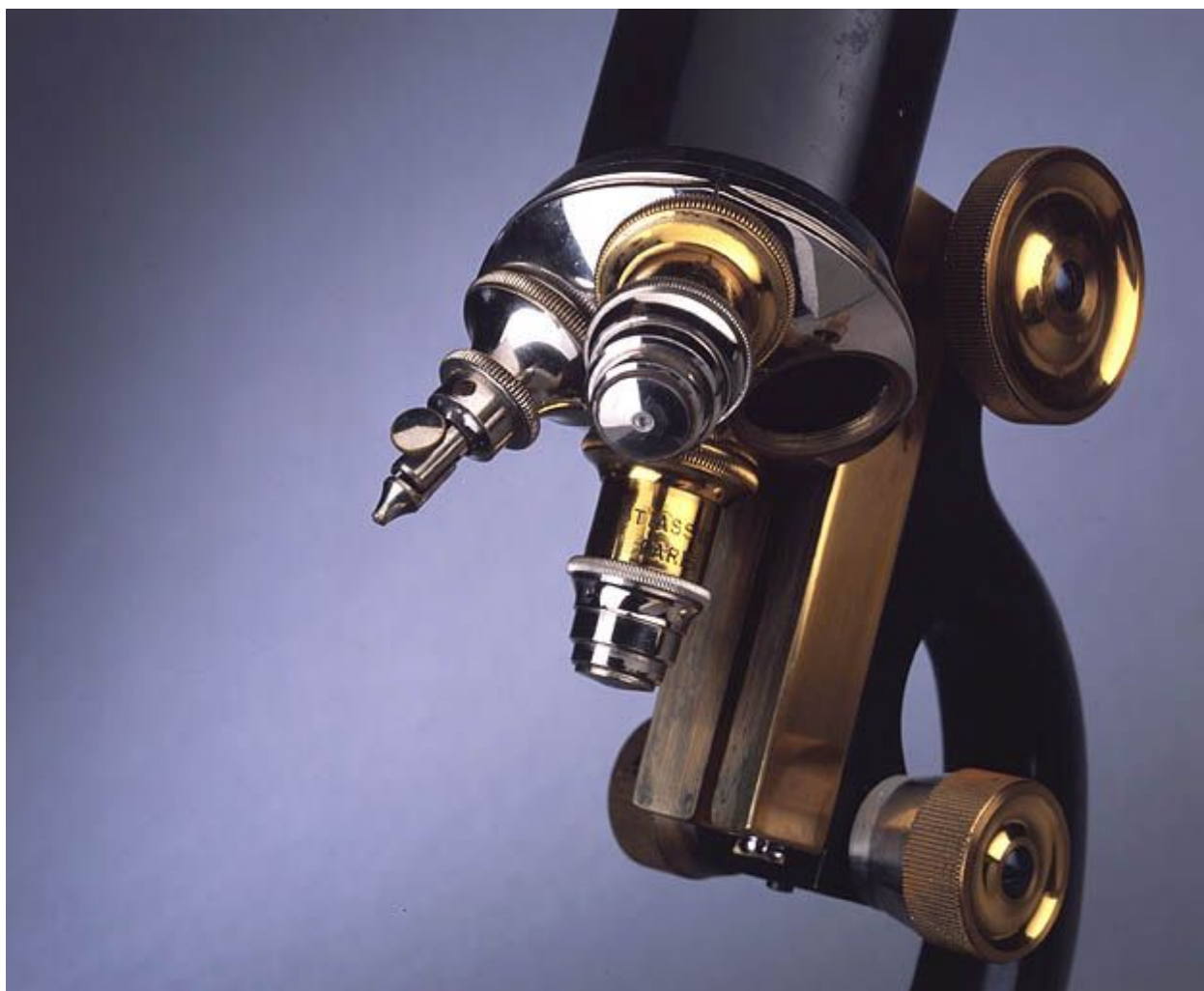
Deuxième microscope : le revolver et ses quatre objectifs.
