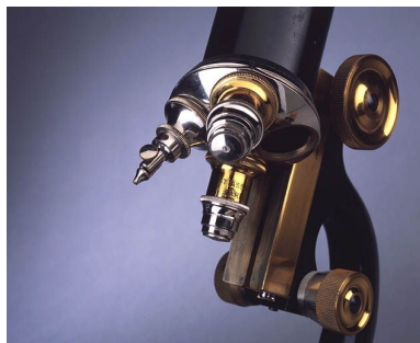
Deuxième microscope : le revolver et ses quatre objectifs. Phot. Jérôme Mongreville IVR43_20023900283XA
