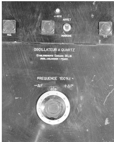
Horloge du Musée du Temps : sélecteur rotatif de l'oscillateur à quartz. Phot. Yves Sancey IVR43_20022501313X
