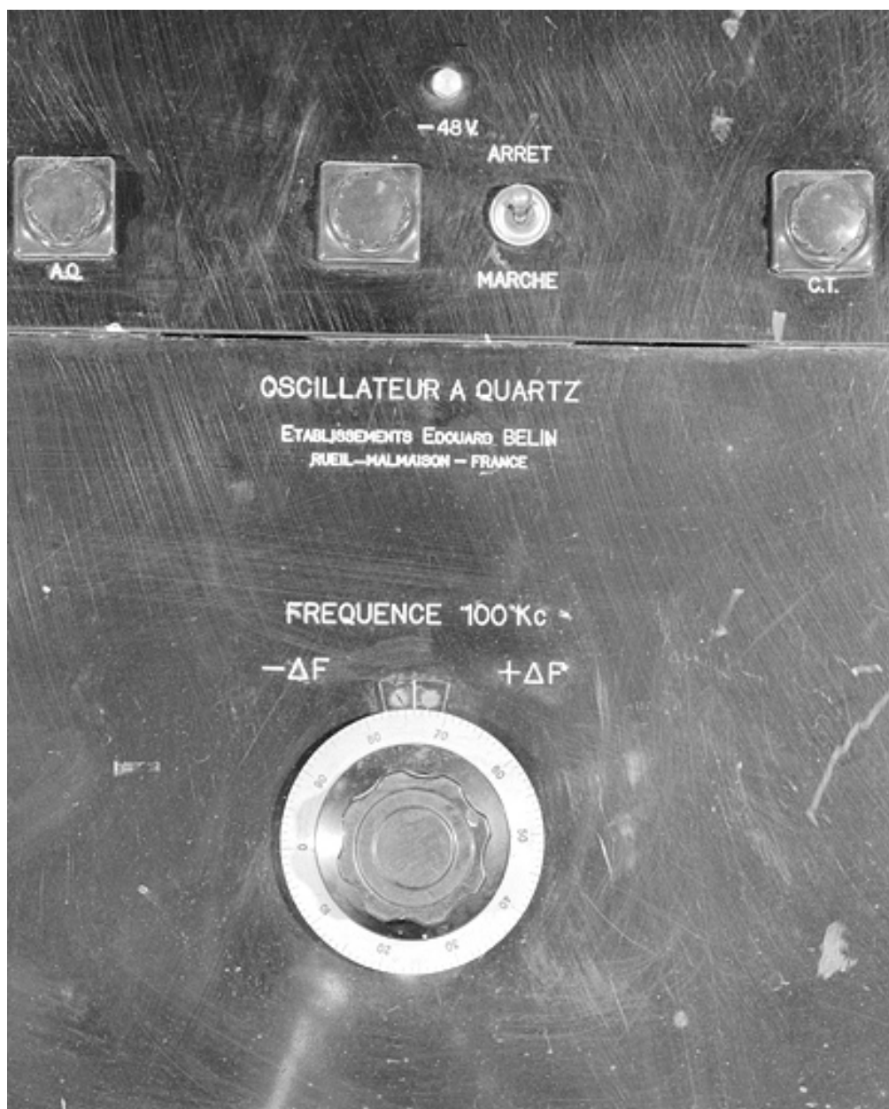
Horloge du Musée du Temps : sélecteur rotatif de l'oscillateur à quartz.
