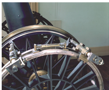
Vue de détail d'un des deux cercles avec niveau et microscopes. Phot. Jérôme Mongreville IVR43_20042500044XA
