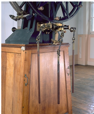
Mécanisme de blocage situé sous chaque cercle de mesure. Phot. Jérôme Mongreville IVR43_20042500049XA
