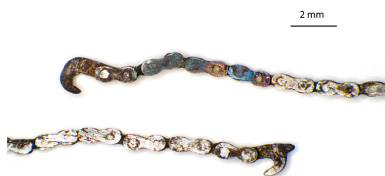
Chaîne de fusée en acier : crochet de la fusée en haut, du barillet en bas.
