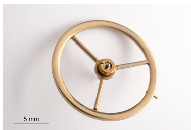
Exemple de balancier pour échappement à cylindre tel que Fallet pouvait en produire à Charquemont. Appelé "dardaine" (du nom de son matériau), le balancier est muni de la virole (ajustée sur son axe) sur laquelle se fixe le spiral. Phot. Sonia Dourlot
