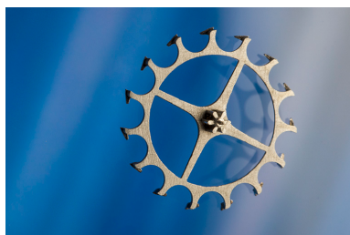
Echappement à cylindre : roue de cylindre, côté pignon. Phot. Sonia Dourlot IVR43_20152500014NUC4A
