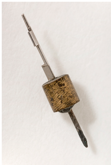
Une verge pour échappement à roue de rencontre. Noter les deux palettes dans la moitié supérieure de l'axe. Phot. Sonia Dourlot IVR43_20152502546NUC4A
