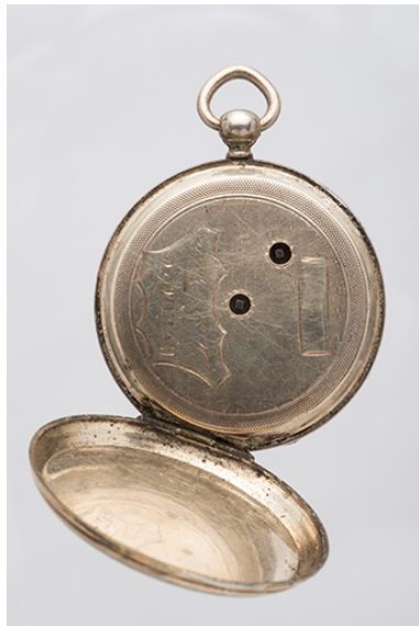
Montre de gousset de la fin du 18e siècle ou du début du 19e siècle : la cuvette. Inscription gravée dans l'écusson : Cylindre / Huit Rubis. Noter les deux trous destinés à la clé utilisée pour le remontage et la mise à l'heure. Phot. Sonia Dourlot IVR43_20152500462NUC4A
