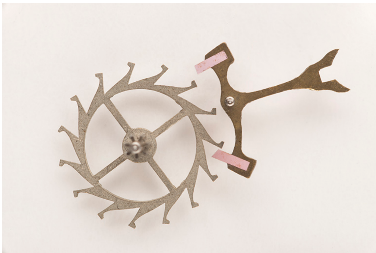
Echappement à ancre : l'ancre et sa roue en position.
