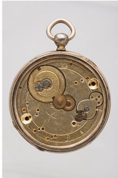
Montre de gousset de la fin du 18e siècle ou du début du 19e siècle : côté cadran (cadran, aiguilles et glace manquent). Noter les traits de compas du planteur de finissage qui a pointé l'emplacement des mobiles (par exemple celui de la roue des secondes, près du centre). Phot. Sonia Dourlot IVR43_20152500459NUC4A
