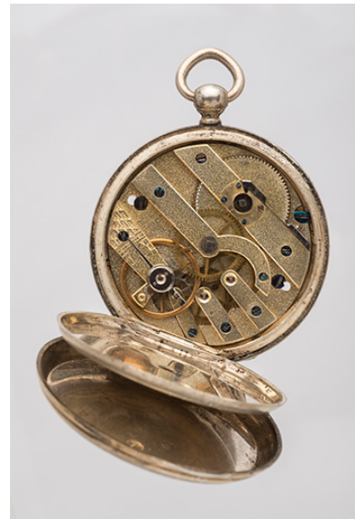
Montre de gousset de la fin du 18e siècle ou du début du 19e siècle : le mouvement (13 ou 13 3/4 li) côté ponts. Phot. Sonia Dourlot IVR43_20152500461NUC4A
