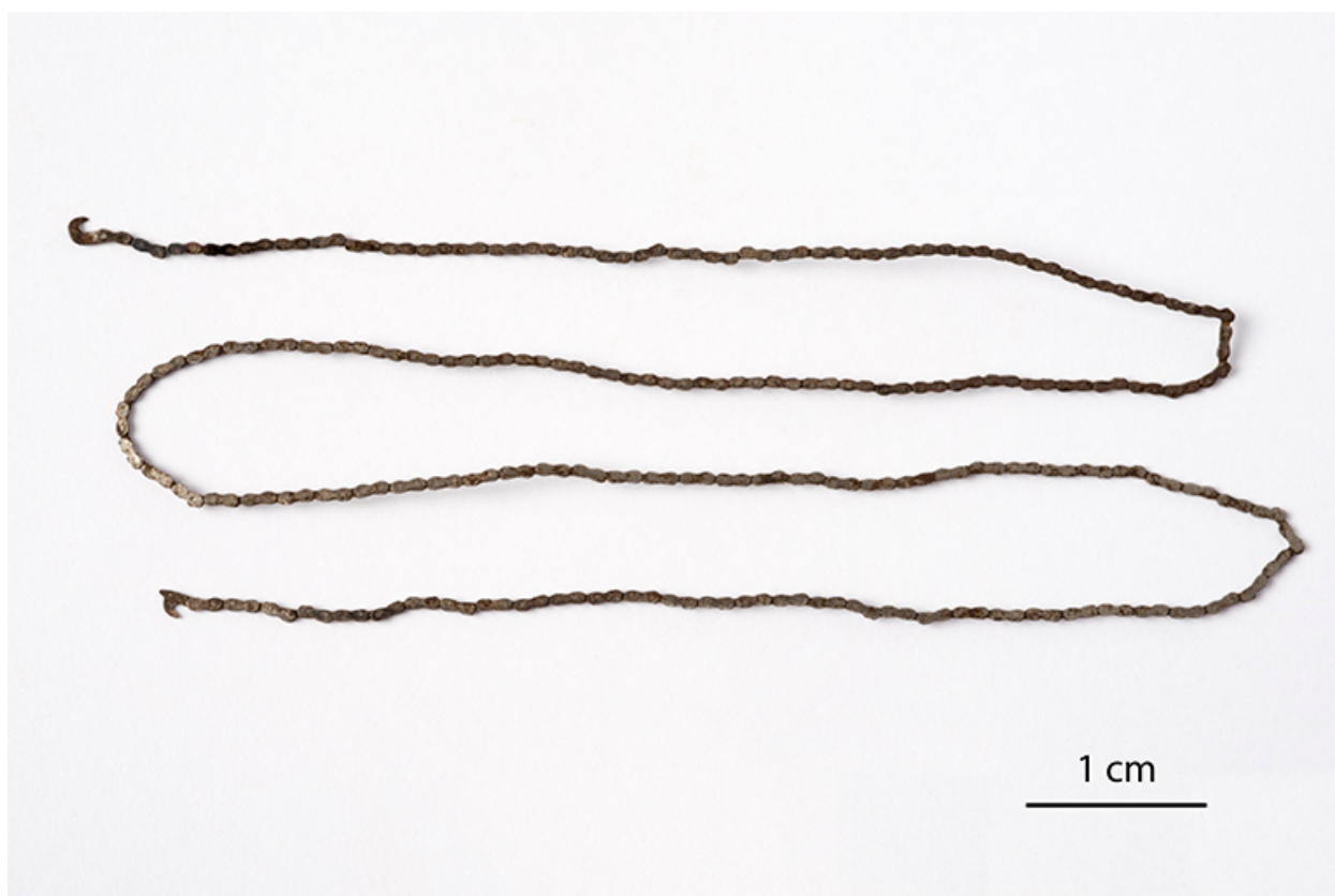
Chaîne de fusée en acier (27 cm de long). Ce type de chaîne était fabriqué à domicile, plutôt par des femmes.
