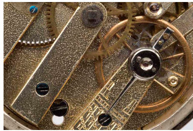
Montre de gousset de la fin du 18e siècle ou du début du 19e siècle : l'échappement à cylindre. Sont visibles le balancier roskopf et son spiral, la raquette et le coq, un pont. Phot. Sonia Dourlot IVR43_20152500465NUC4AQ
