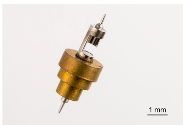
Echappement à cylindre : cylindre (en métal blanc) équipé de la "siette" (assise du balancier) en laiton. Phot. Sonia Dourlot IVR43_20152500016NUC4A
