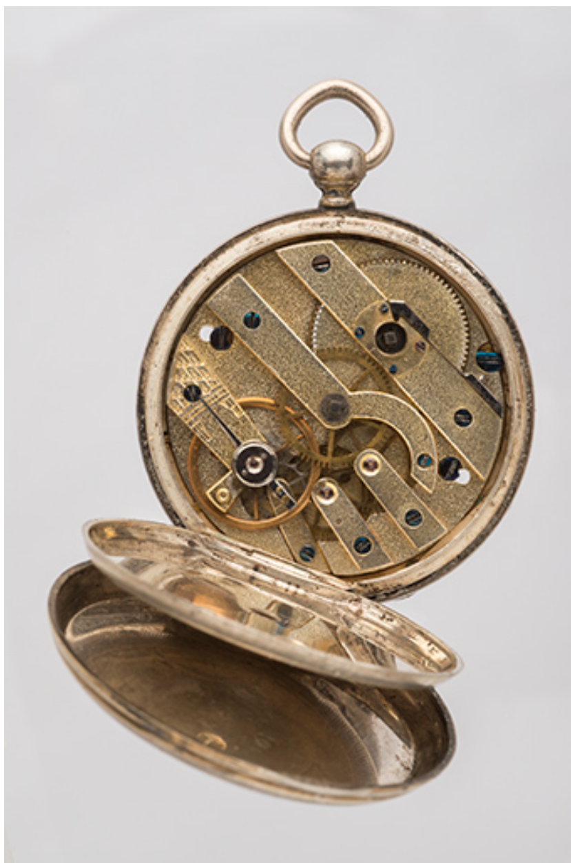
Montre de gousset de la fin du 18e siècle ou du début du 19e siècle : le mouvement (13 ou 13 3/4 li) côté ponts.
