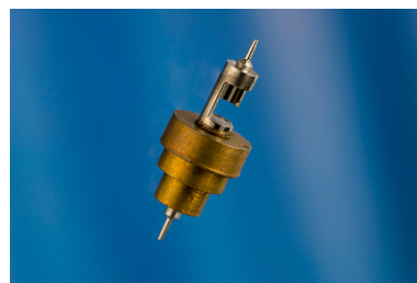
Echappement à cylindre : cylindre (en métal blanc) équipé de la "siette" (assise du balancier) en laiton. Phot. Sonia Dourlot IVR43_20152500015NUC4A
