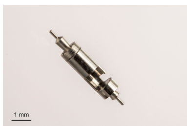
Echappement à cylindre : cylindre 18 ligne commercialisé par le comptoir Cyrax. Phot. Sonia Dourlot IVR43_20152500020NUC4A
