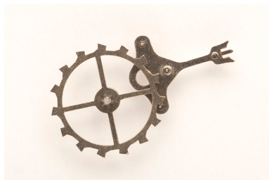
Echappement à chevilles : l'ancre et sa roue en position. Phot. Sonia Dourlot IVR43_20152500226NUC4A
