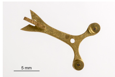
Echappement à chevilles : ancre (2e face). Phot. Sonia Dourlot IVR43_20152500017NUC4A
