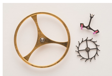
Echappement à ancre : balancier, ancre et roue d'ancre. Phot. Sonia Dourlot IVR43_20152500223NUC4A
