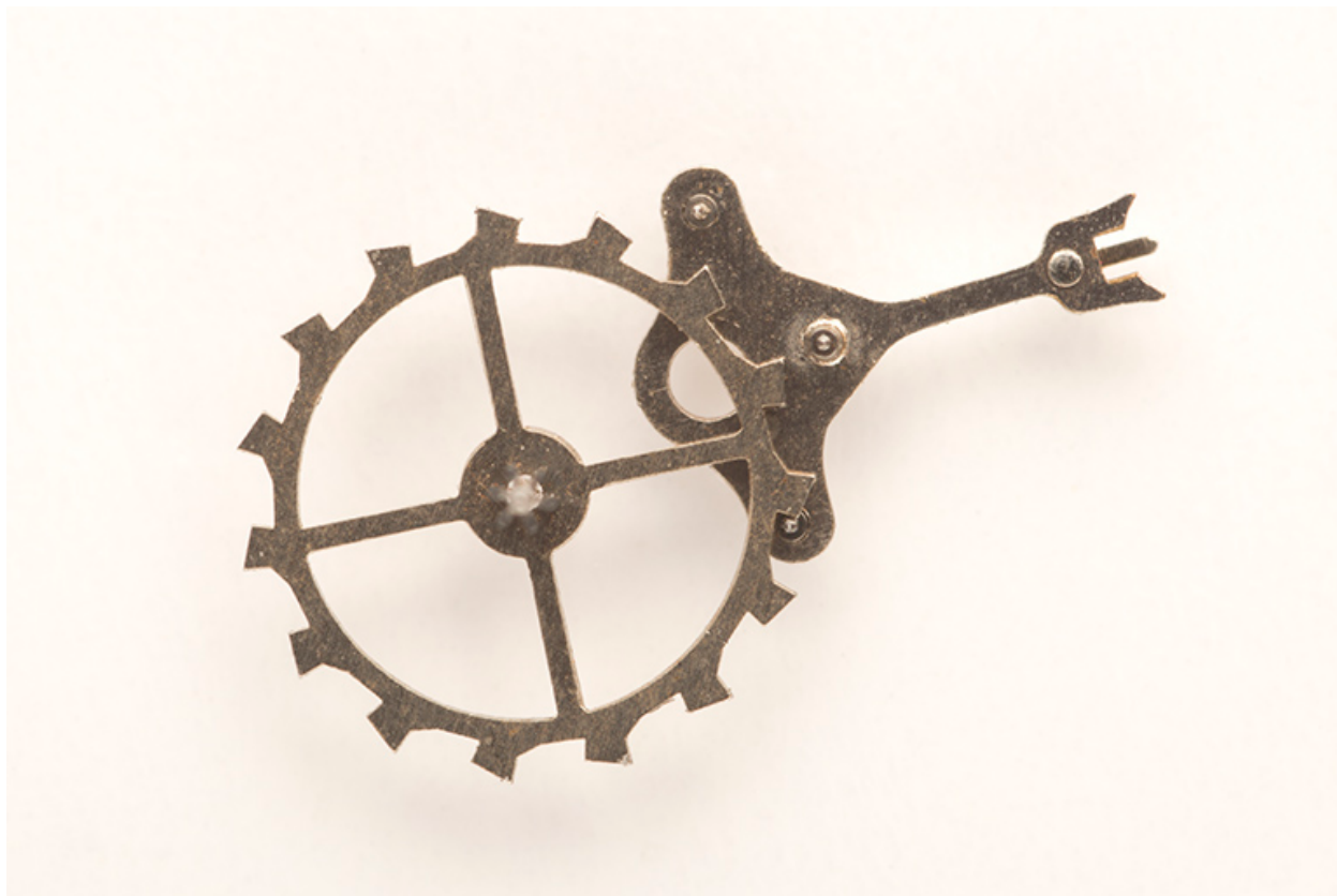
Echappement à chevilles : l'ancre et sa roue en position.
