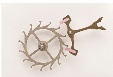
Echappement à ancre : l'ancre et sa roue en position. Phot. Sonia Dourlot IVR43_20152500221NUC4A
