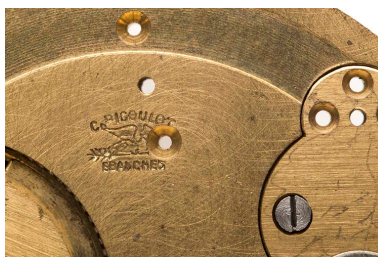
Platine nue, côté cadran : marque du fabricant avec inscription (C. Picoulot / Ebauches) et griffon couché sur une flèche.
