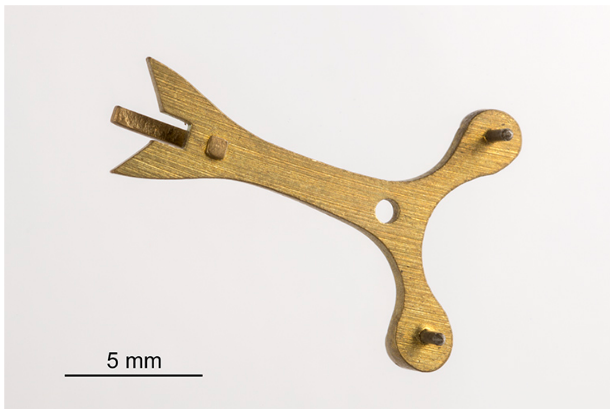
Echappement à chevilles : ancre (les chevilles sont visibles à droite).
