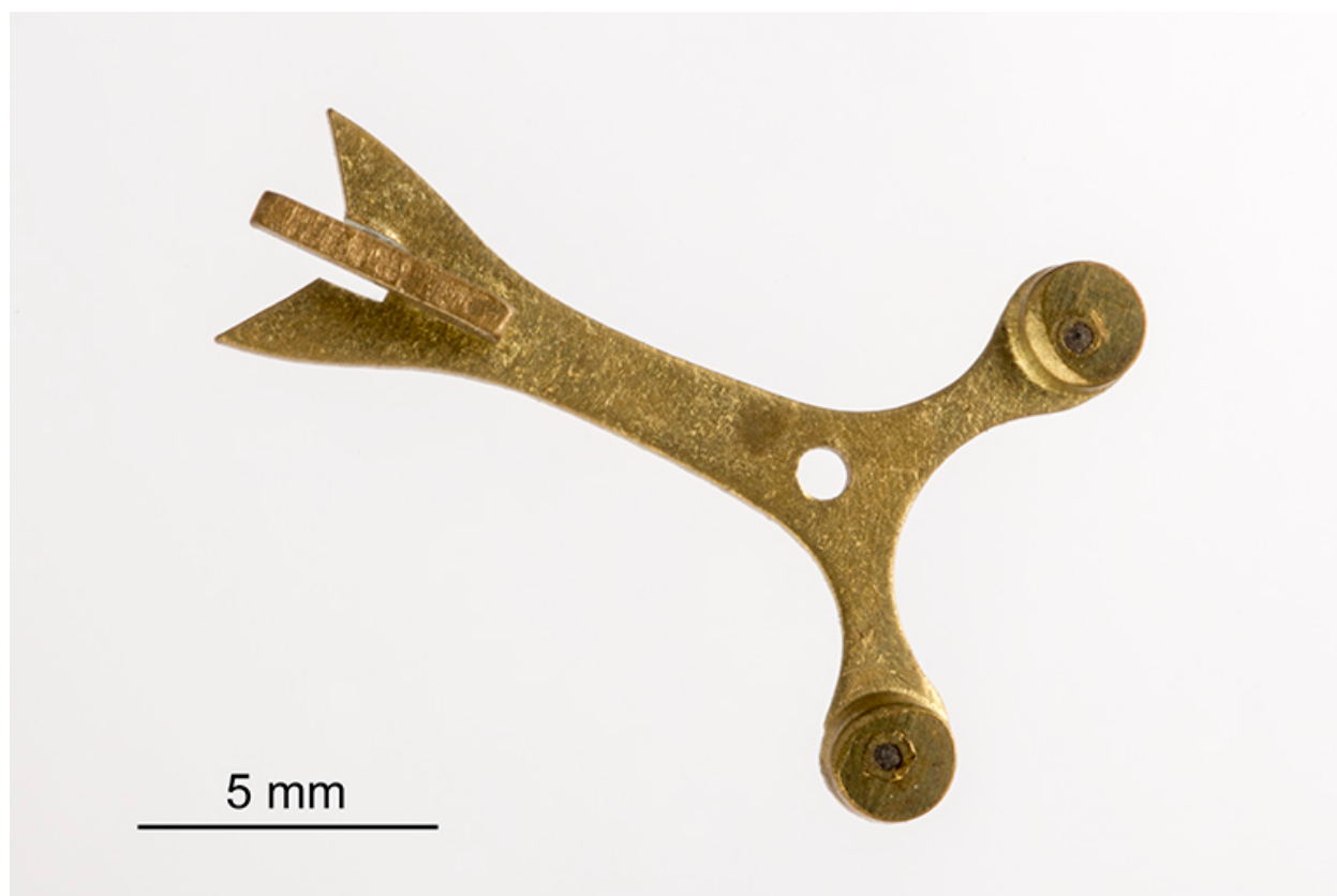
Echappement à chevilles : ancre (2e face).
