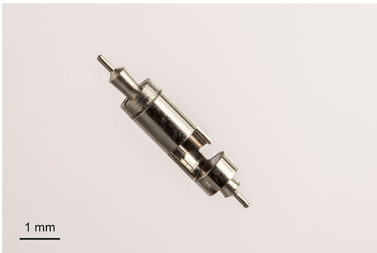
Echappement à cylindre : cylindre 18 ligne commercialisé par le comptoir Cyrax.
