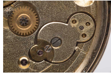
Montre de gousset de la fin du 18e siècle ou du début du 19e siècle : le chariot ou char (pièce mobile destinée au réglage de la distance entre les centres du cylindre et de sa roue). Phot. Sonia Dourlot IVR43_20152500463NUC4A
