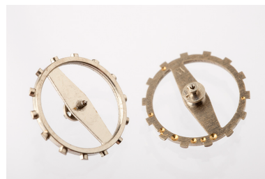
Deux balanciers monométalliques. Les vis sont purement décoratives, le réglage du balourd se faisant par fraisage au verso (balancier de droite, montrant également les plateaux et la cheville pour un échappement à ancre). Phot. Sonia Dourlot
