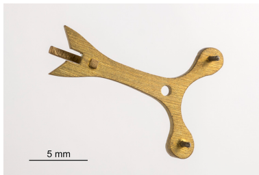
Echappement à chevilles : ancre (les chevilles sont visibles à droite). Phot. Sonia Dourlot IVR43_20152500018NUC4A
