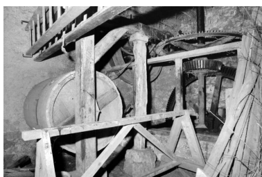
Tonneau de polissage et transmission. Phot. Laurent Poupard IVR43_19923901242Z
