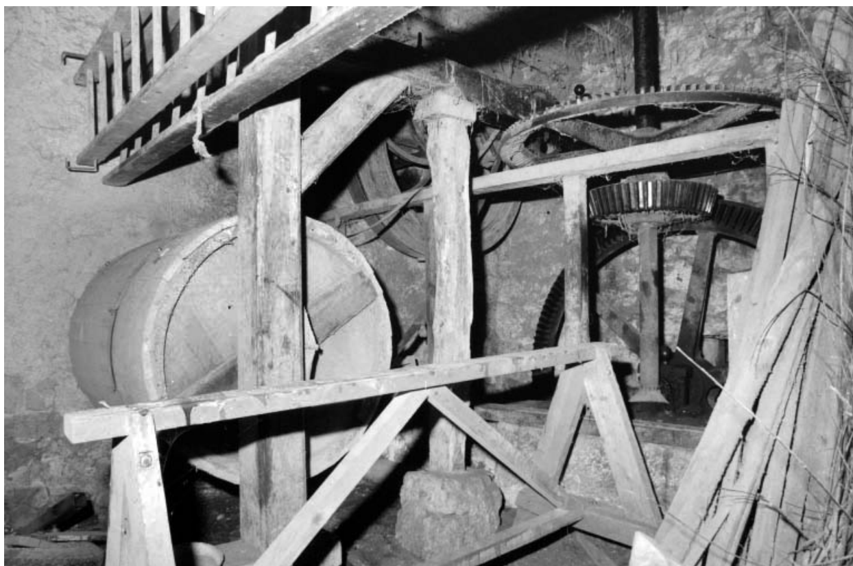
Tonneau de polissage et transmission.
