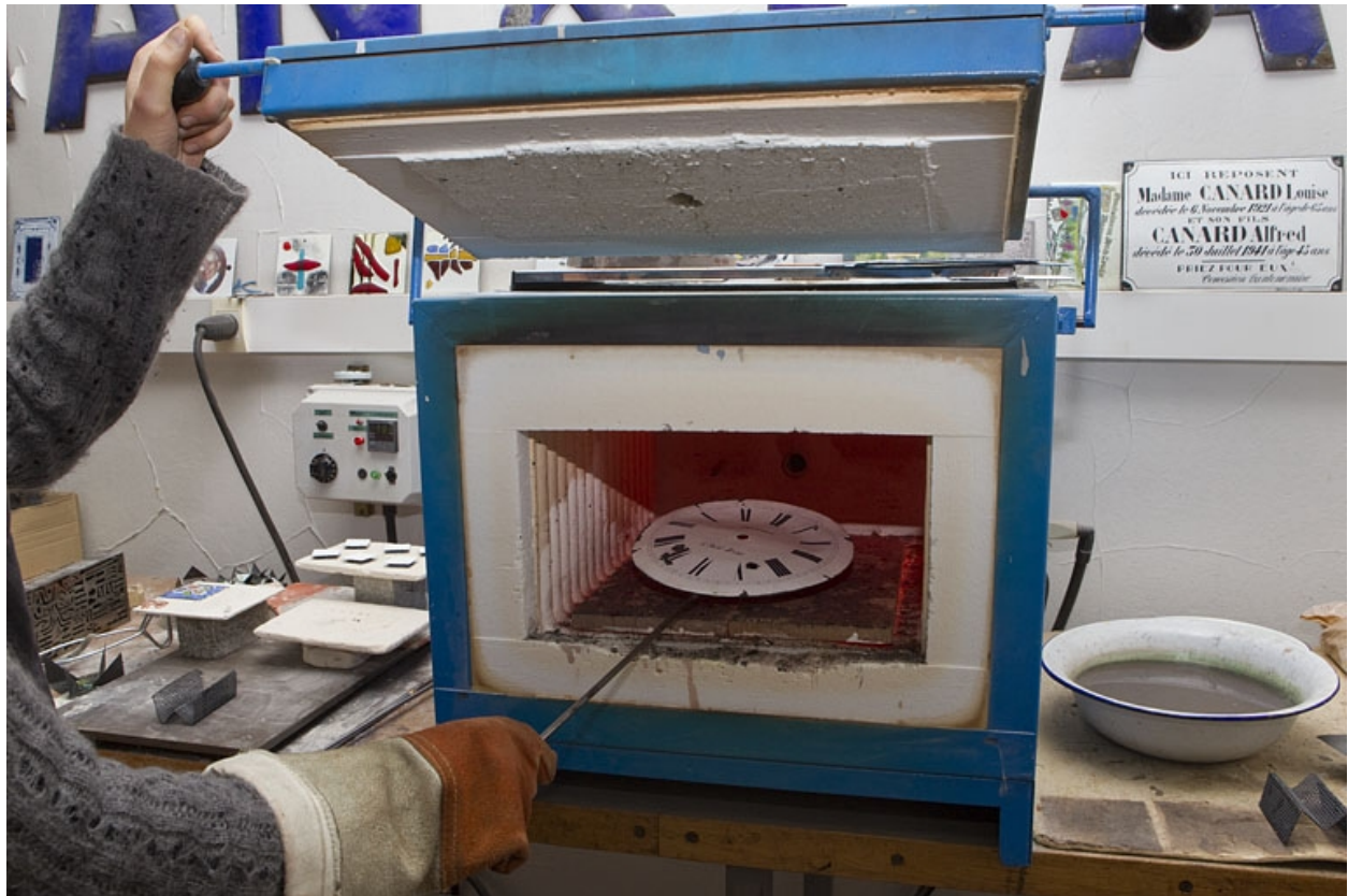
Enfournement d'un cadran émaillé : le four.
