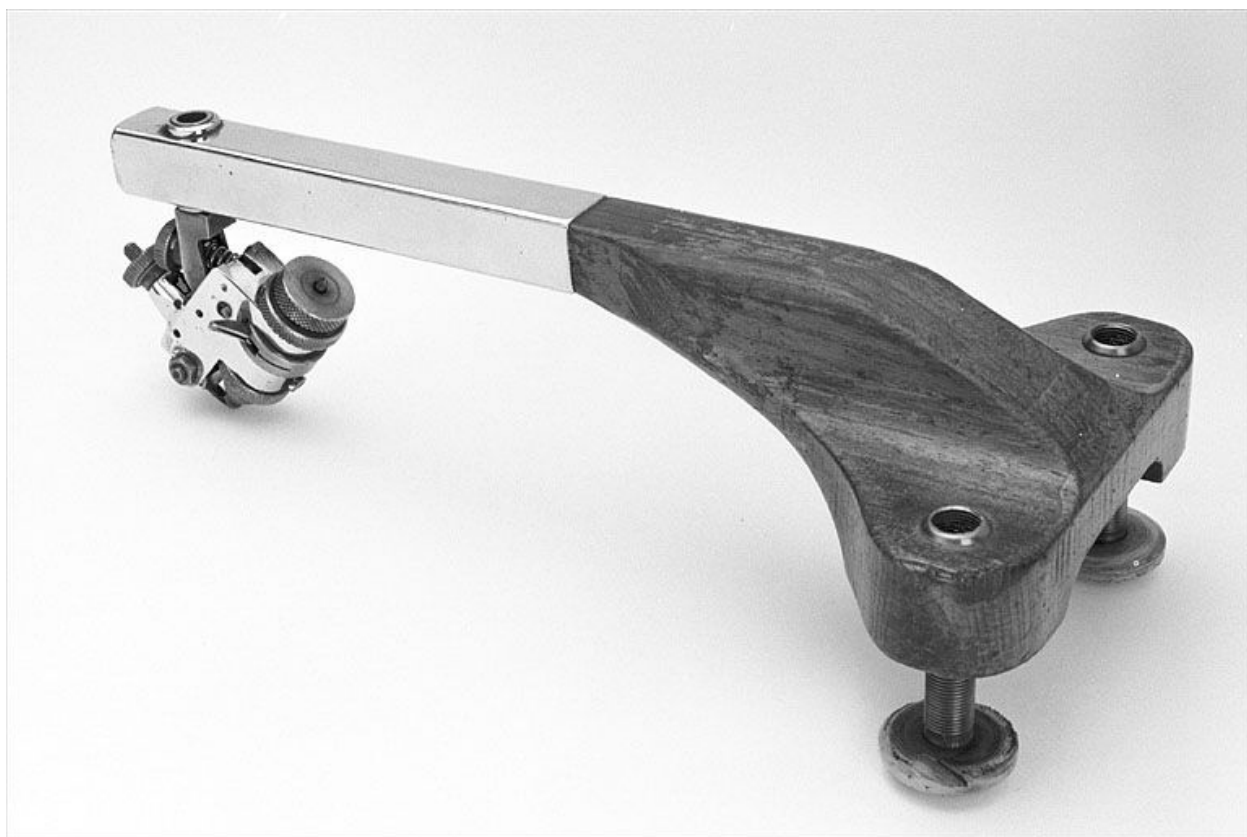
Pince mécanique (tenaille de lapidaire), vue du côté du diamantaire.
