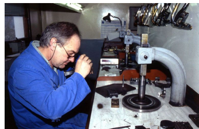
Contrôle en cours de taille d'un diamant. Phot. Jérôme Mongreville IVR43_20013900845ZA
