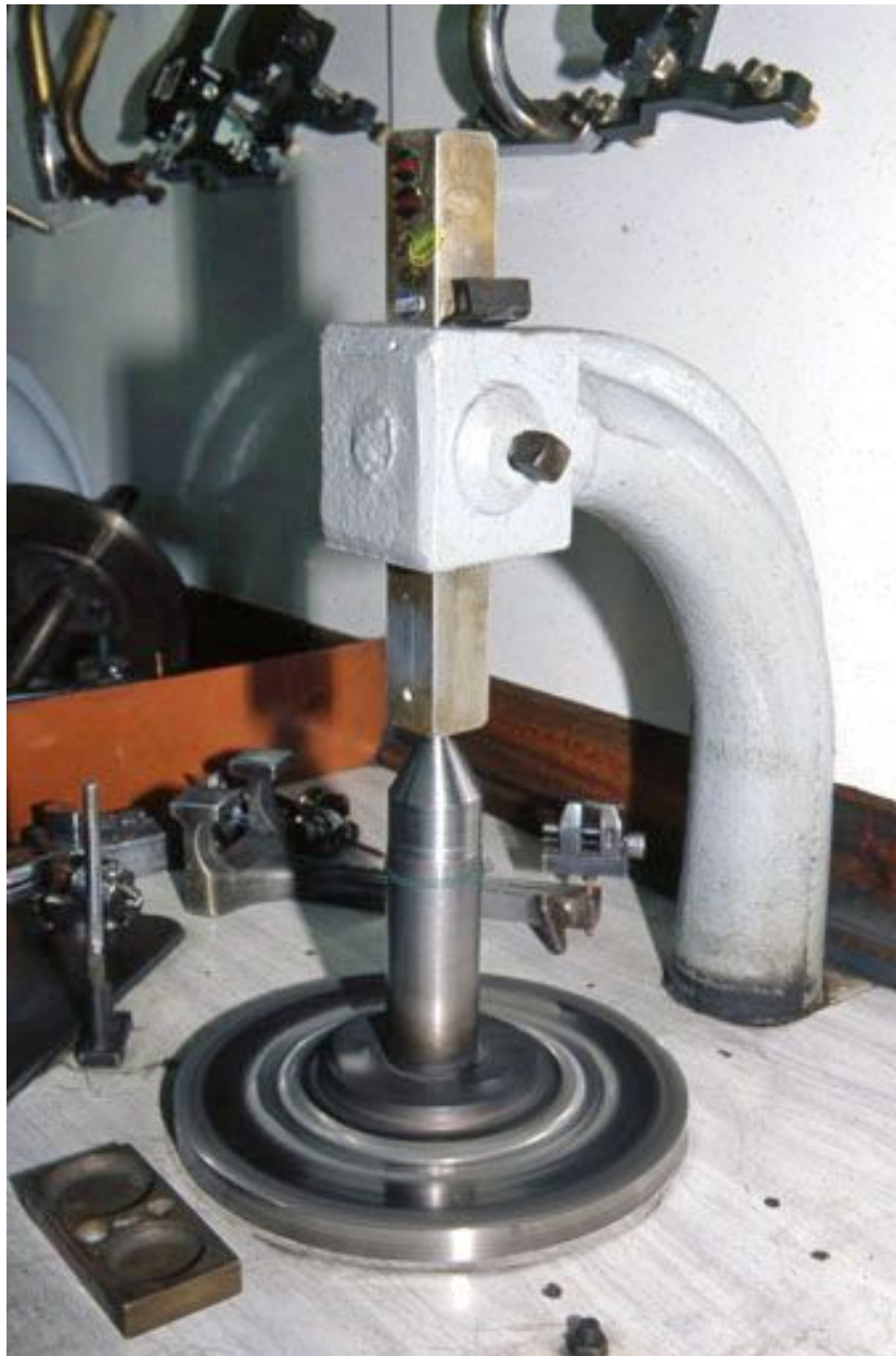
Meule et son système de fixation.
