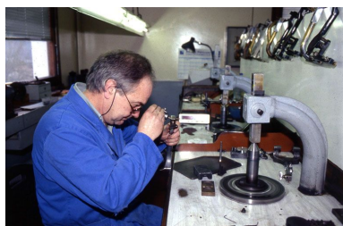
Contrôle en cours de taille d'un diamant. Phot. Jérôme Mongreville IVR43_20013900846ZA
