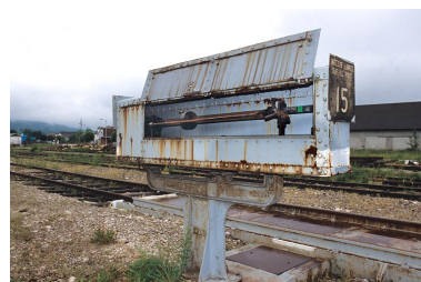
Appareil indicateur, vu de trois quarts droite (caisse ouverte). Phot. Yves Sancey IVR43_20053900066ZA
