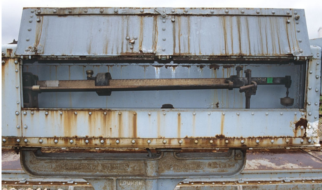
Appareil indicateur, caisse ouverte, montrant le fléau à la romaine.
