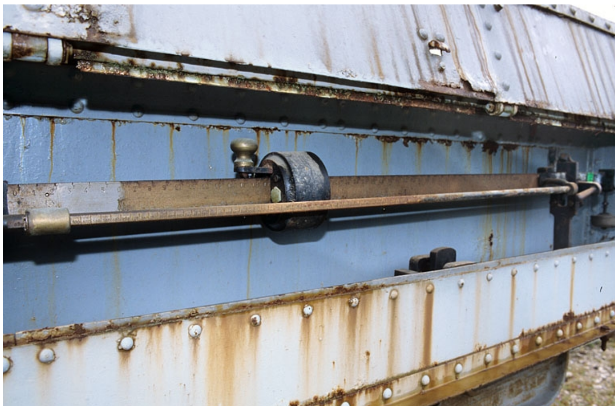
Appareil indicateur : le fléau à la romaine.
