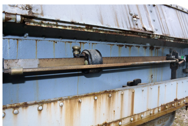
Appareil indicateur : le fléau à la romaine. Phot. Yves Sancey IVR43_20053900067ZA
