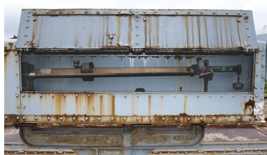
Appareil indicateur, caisse ouverte, montrant le fléau à la romaine. Phot. Yves Sancey IVR43_20053900064ZA
