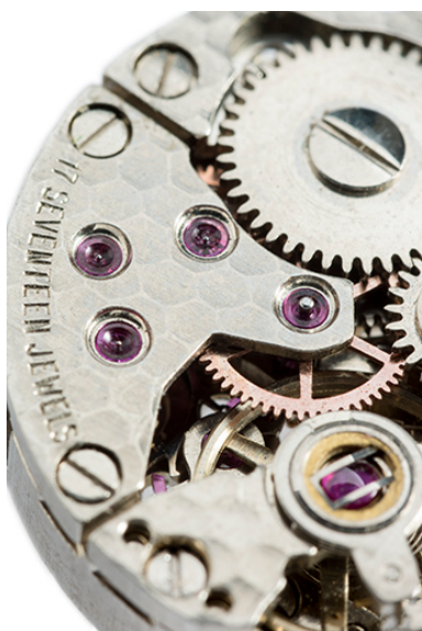
Mouvement FE 68-A : inscription et rubis sur le pont de rouage, avec amortisseur de chocs Epsilon Antichoc 102 au premier plan. Phot. Sonia Dourlot IVR43_20162500740NUC4A
