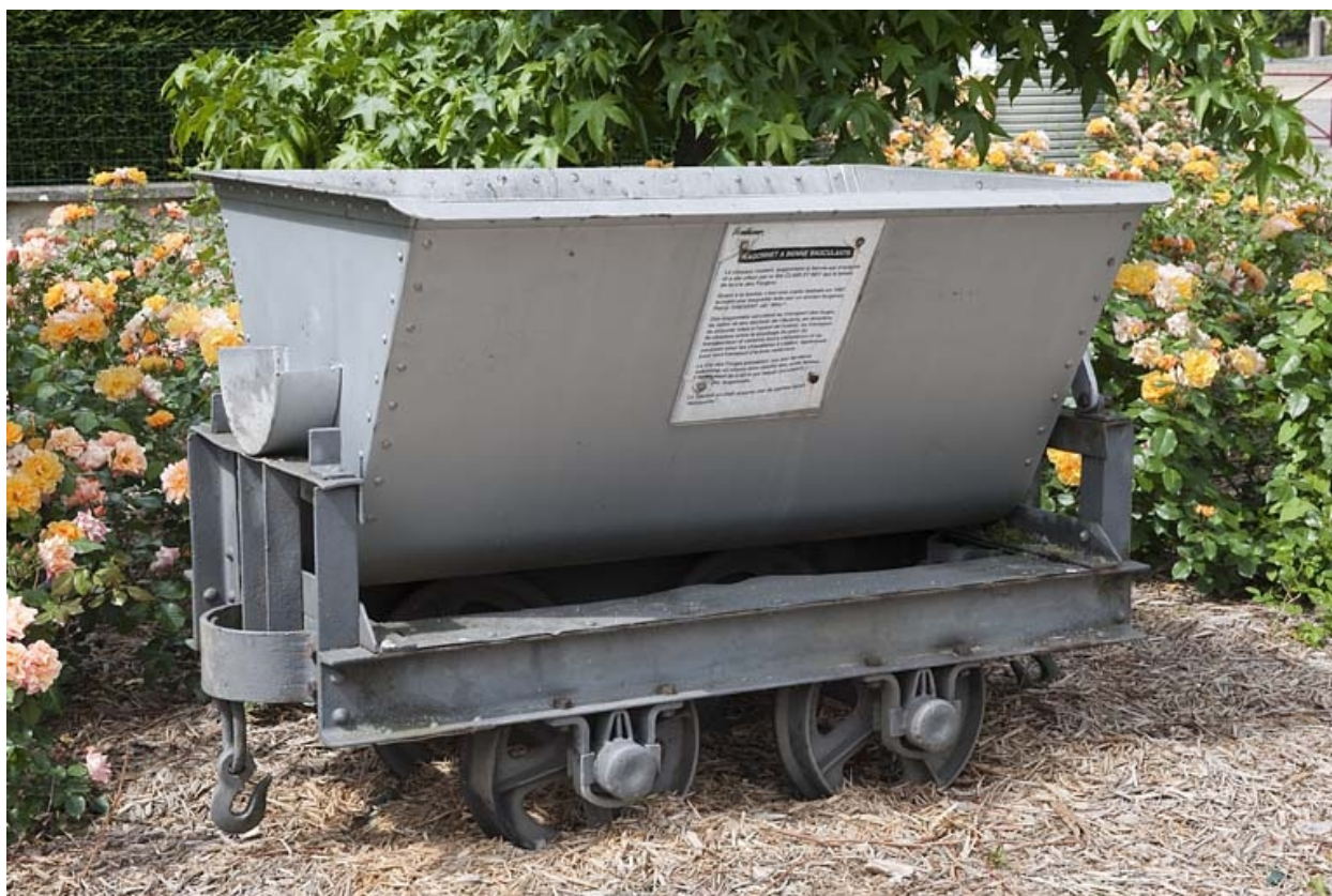
Wagonnet servant au transport du laitier vers le crassier, tiré par des locomotives "Decauville" (seul le châsis est d'origine).
