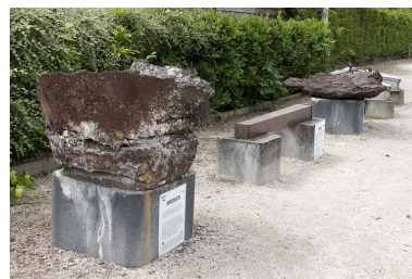
Pièces diverses exposées à proximité du site : loup (ou laitier, résidus agglomérés issus du démoulage) et lingot d'acier. Phot. Jérôme Mongreville IVR43_20122501247NUC4A
