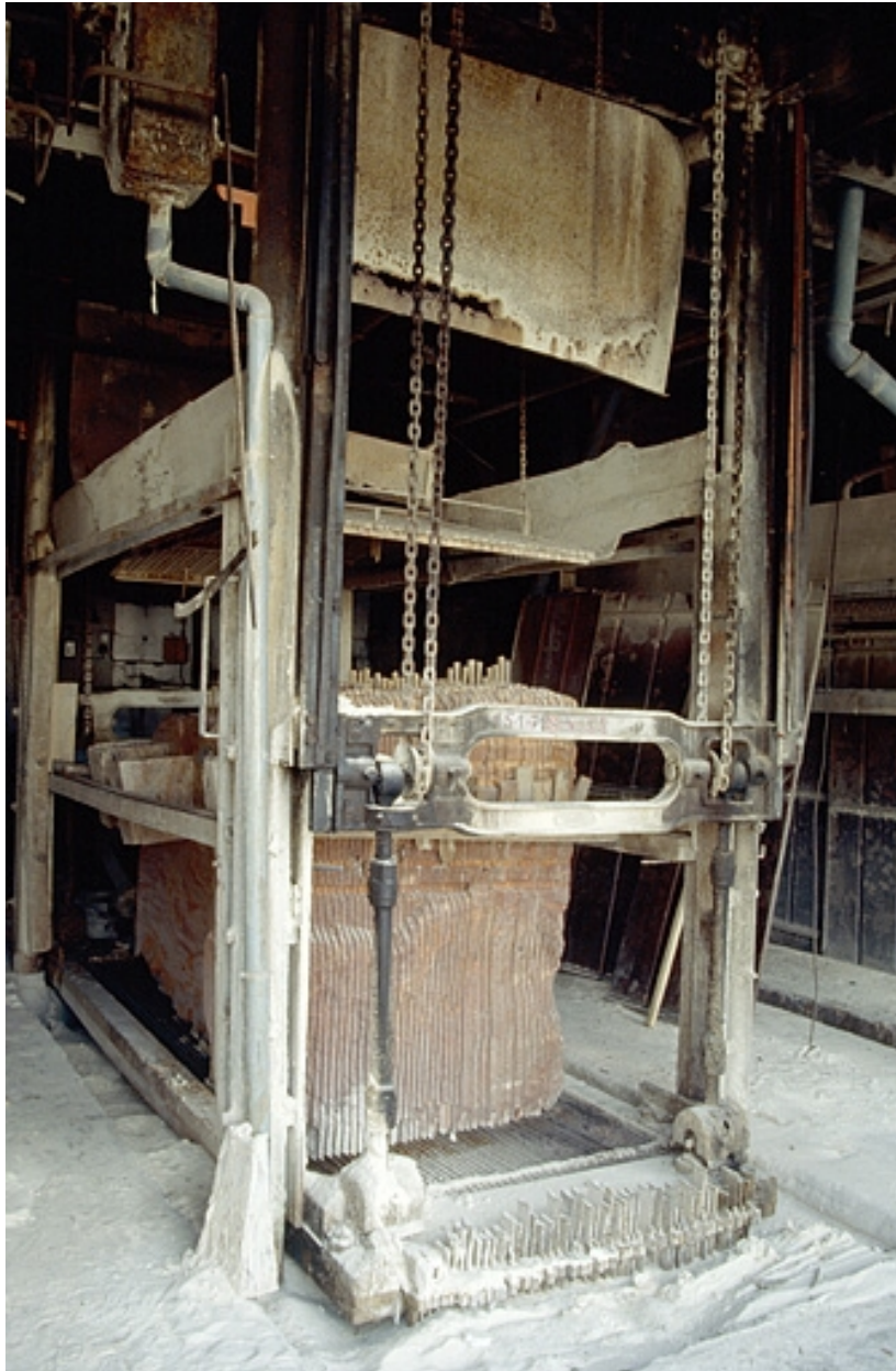
Usine de taille de matériaux de construction Célard, à Saint-Amour : l'un des sept châssis de scie multilames.
