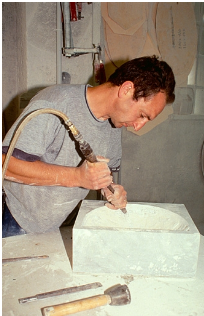
Usine de taille de matériaux de construction Célard, à Saint-Amour : creusage d'un lavabo.
