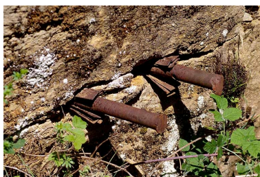
Carrière des Carrats, à Graye-et-Charnay : détail de coins encore en place dans le front de taille. Phot. Yves Sancey IVR43_19973901630ZA
