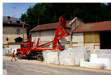
Usine de taille de matériaux de construction Yelmini Artaud, à Balanod : déchargement d'un bloc de marbre de Balanod. Phot. Yves Sancey IVR43_19973901705ZA
