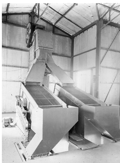
Atelier de concassage. Cribles vibrants. Phot. Emile Hérissé, Phot. Emile Hérissé IVR43_20077000470NUCA
