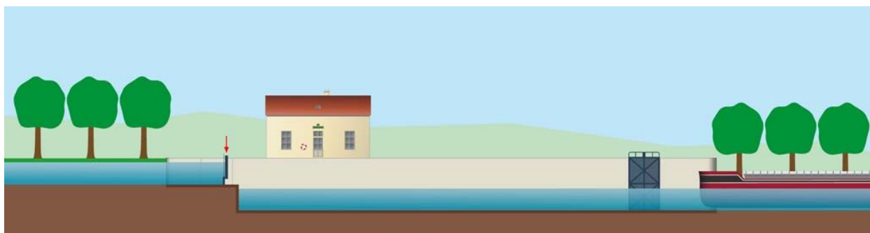
Schéma d'éclusage d'un bateau montant, étape 2.
