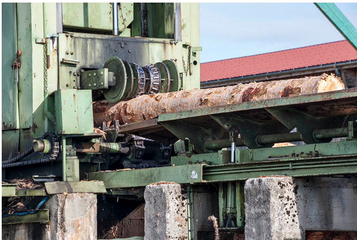
Détail du poste d'écorçage.
