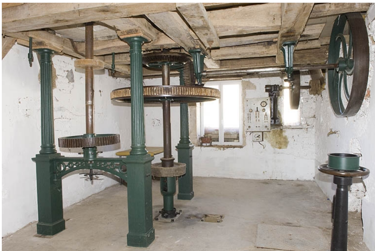
Beffroi du moulin.
